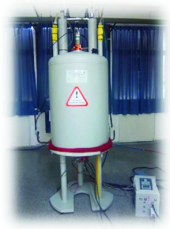
**Figura 3.4:** a) *Imán superconductor Bruker de 7 T (300 MHz para  $^1\text{H}$ ).*
