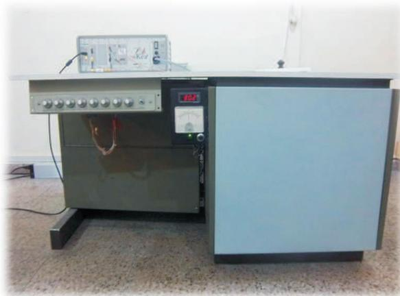
**Figura 3.5:** *Imán permanente Varian de 1.4 T (60 MHz para  $^1\text{H}$ ) con la consola Kea2 de Magritek.*
