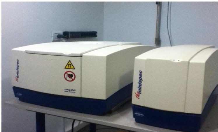
**Figura 3.6:** *Espectrómetro BRUKER MINISPEC mq 20 utilizado para realizar los experimentos con control de temperatura.*
