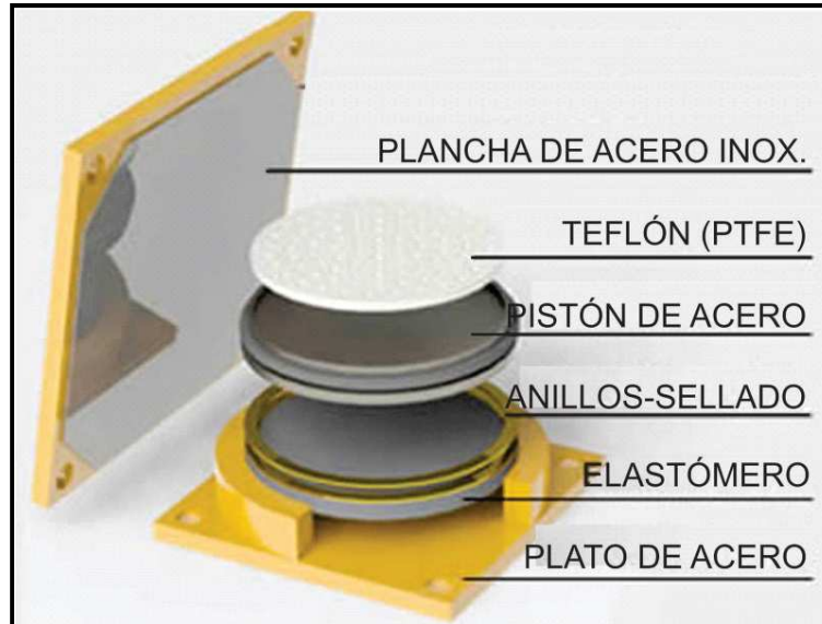
Figura 6.27. Apoyo deslizante tipo POT
