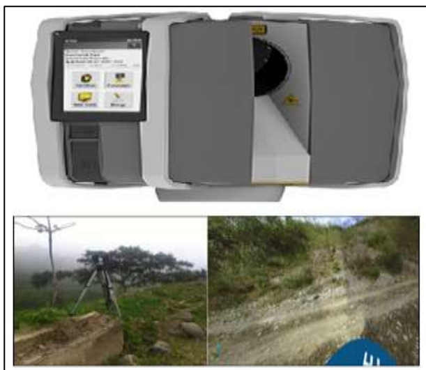
FIG I.04 Scanner Lasser 3D / Lidar lateral. Toma en el área de estudio (remoción en masa)
