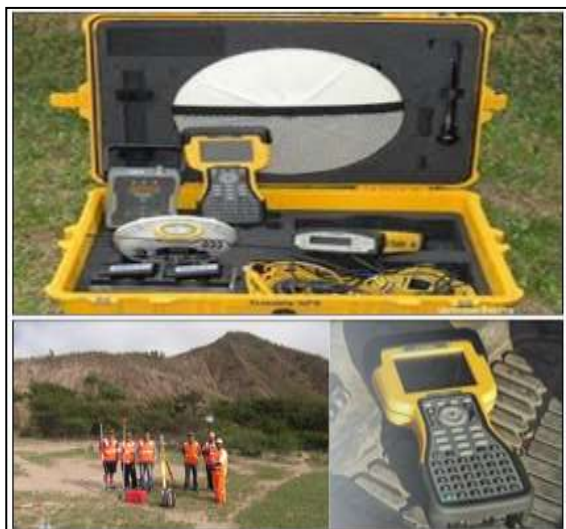
FIG I.07 GPS DIFERENCIAL R8 (precisión y exactitud) Levantamiento de puntos de control para ajuste
