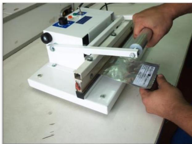
**Figura 10.** Máquina selladora de pouches trilaminados
