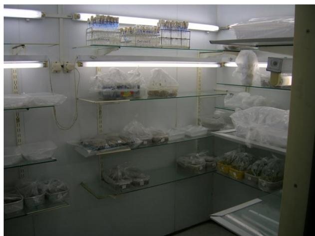
**Figura 7.** Cámara de germinación para test de PG
