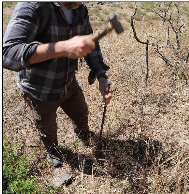
Figura 5: Medición de la profundidad del suelo con varilla metálica graduada.
