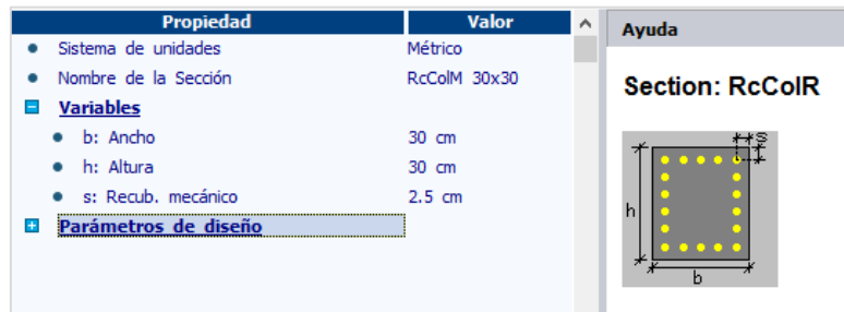
Figura 4.2. RAM – Sección de columna
