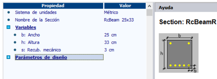
Figura 4.6. RAM – Sección de viga de fundación 25cmx33cm
