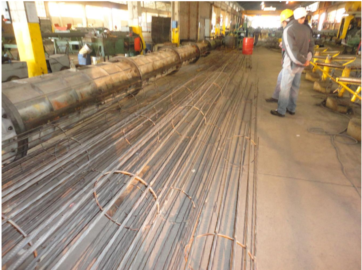
FIGURA 10. FABRICACIÓN DE UN POSTE
