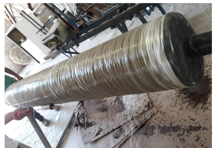
Rollo de Fibra de Vidrio y forma de aplicación al producto:
