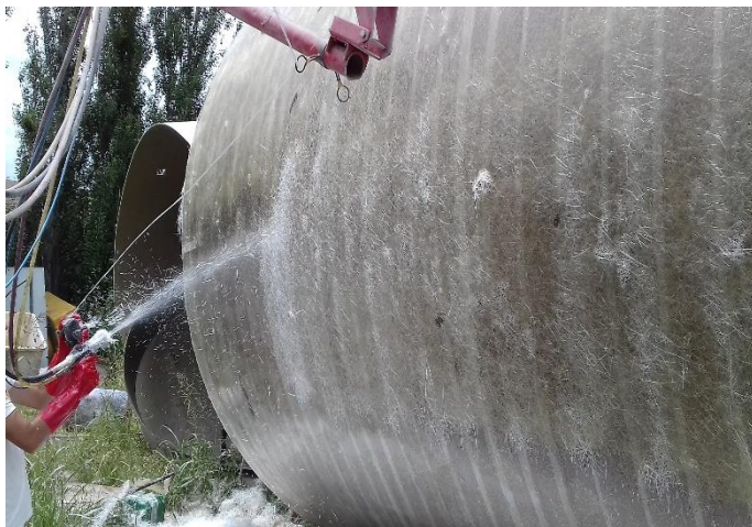
Rollo de Fibra de Vidrio y forma de aplicación al producto:
