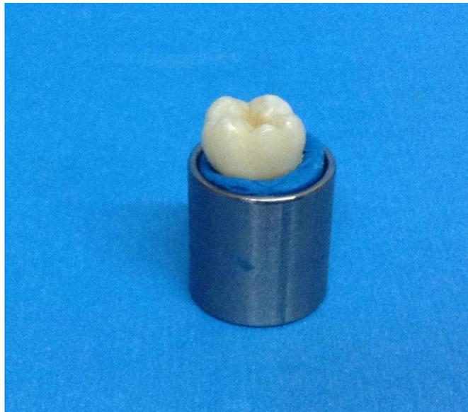
**Figura 1:** *Tubo de acero inoxidable con uno de los dientes incluido en silicona de alta densidad.*
