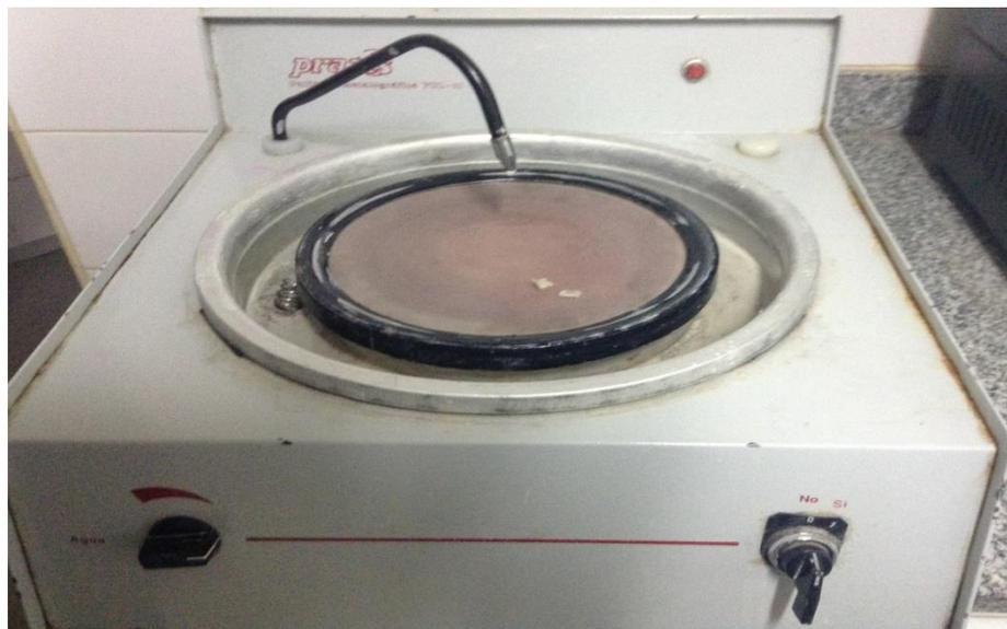
**Figura 19:** Pulidora metalográfica Praxis 01 (Argentina).
