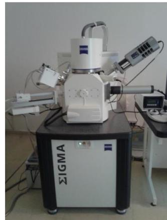
**Figura 24:** Microscopio Electrónico de Barrido de Emisión de Campo EDS FEG SEM SIGMA (Zeiss, Germany).
