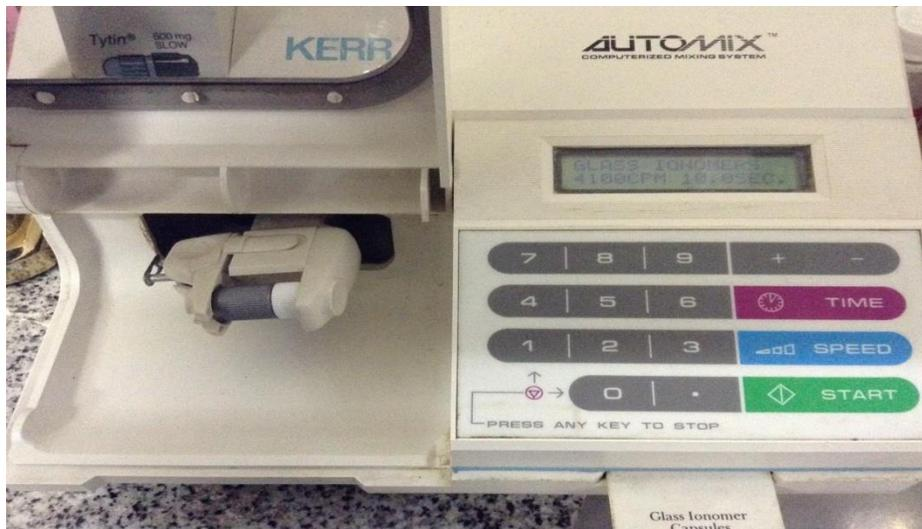
**Figura 13:** *Amalgamador computarizado de ultra alta velocidad (Automix Computerized Mixed System, Kerr Co. USA).*
