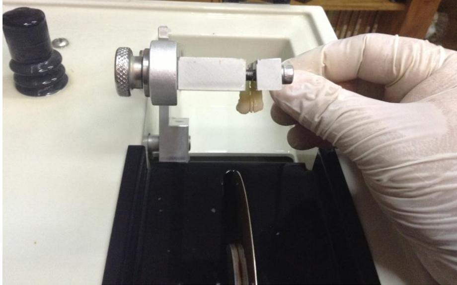
**Figura 18:** Corte de los dientes en sentido buco-lingual en láminas de 250 $\mu$ m con Isomet 1000.
