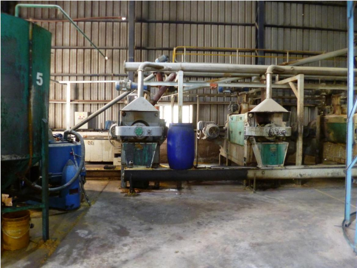
El aceite crudo junto con algo de sólidos pasa a través de las ranuras de la prensa, para luego ser enviado al decantador a través de un sinfín (Figuras 15
