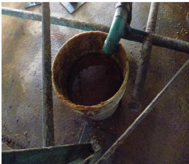
Una vez precipitado los fosfátidos, el aceite es bombeado a los tanques depósitos finales y la goma (figura 20) es reinyectada al proceso.
