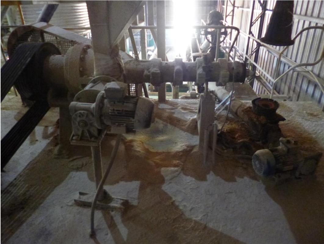
El extrusado produce una serie de efectos: -La desactivación de los factores antinutricionales de la soja; - la rotura y desmenuzamiento del grano, reduciendo el trabajo que debe realizar posteriormente la prensa para la extracción del aceite; - descenso de la humedad contenida (secado) del grano por la pérdida en forma de vapor a la salida y - calentamiento de la masa a prensar, disminuyendo la viscosidad del aceite, y permitiéndole fluir con facilidad (Global Extent S.R.L., 2013a).
