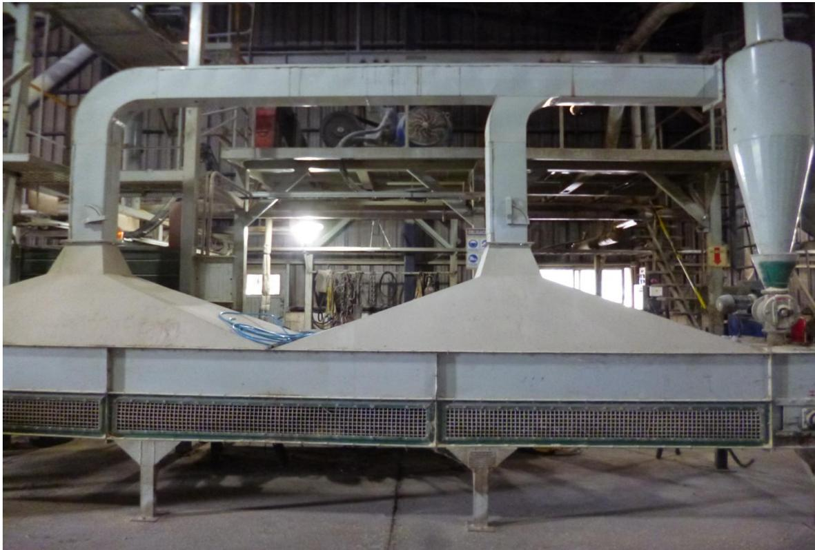
El expeller proveniente del enfriador es almacenado en cuatro tolvas sobre-elevadas (Figura 22) con capacidad de 35/40 T c/u, desde las cuales se puede cargar a granel a través de un redler y una rosca sinfín.
