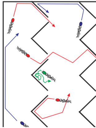
Figura 2.2: Esquema de la trayectoria de las bacterias cuando interacciona con los defectos. Los mismos funcionan como un ratchet geométrico cuya dirección de fácil movimiento es de izquierda a derecha, generándose un direccionamiento en esta dirección.
