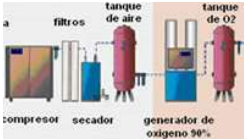
Ilustración 17.-Ejemplo de producción de oxígeno por PSA
