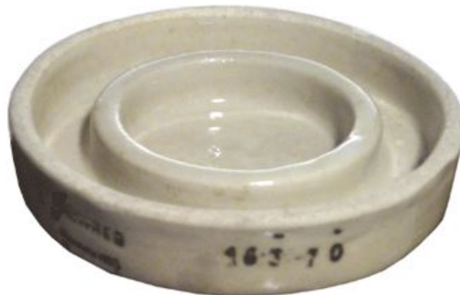
-Figura 39. Cámara de comway.
