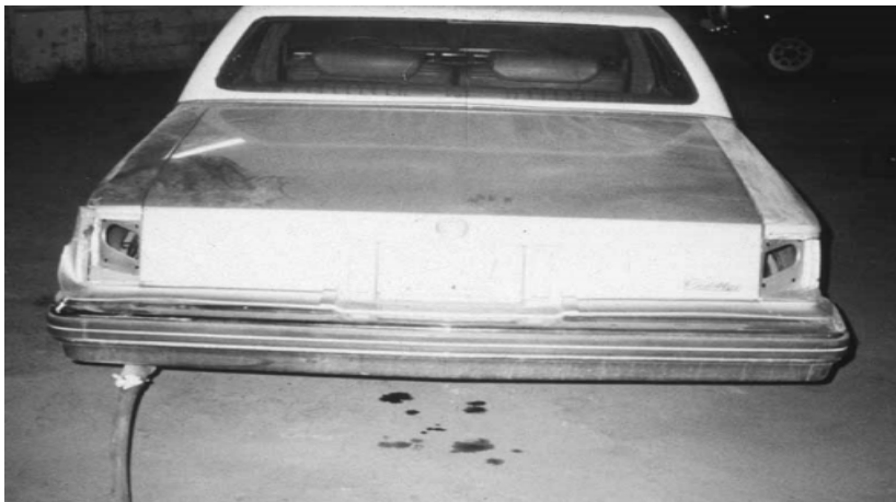
-Figura 16. . Envenenamiento por CO conectando el escape al interior del vehículo mediante una manguera
