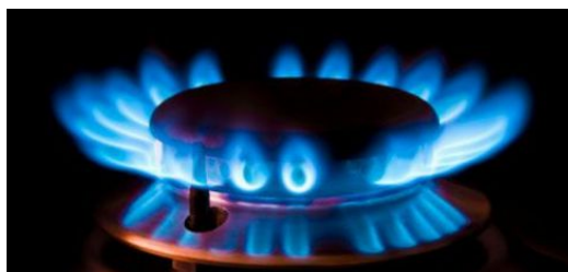
-Figura 38. Llama azul, signo de buena combustión.
