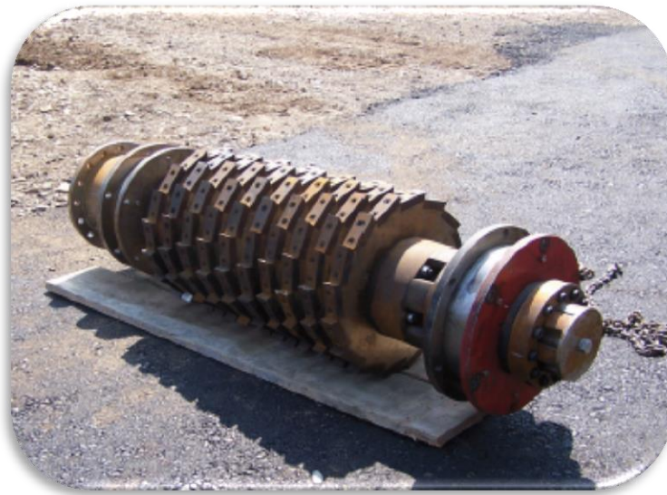
Figura 22 – Eje con cuchillas de corte
