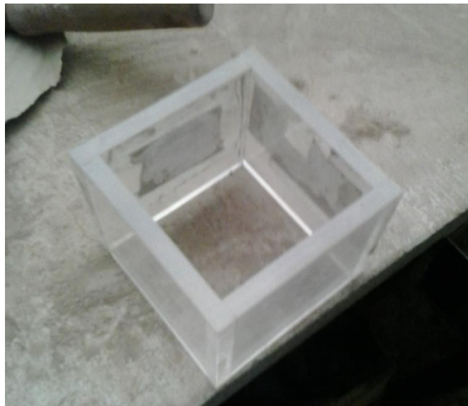
Figura 3.4. Cubo acrílico para tallar muestras inalteradas.
