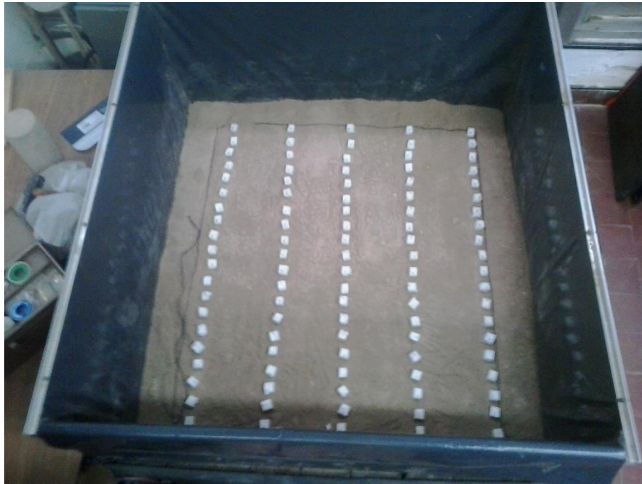
Figura 4.13. Cajón impermeable con electrodos de medición para método de calicata.
