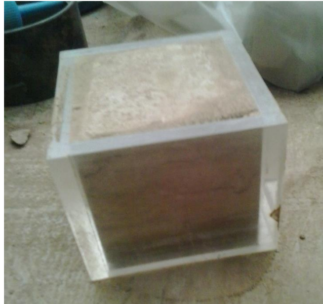
Figura 3.5. Cubo acrílico con muestra tallada.
