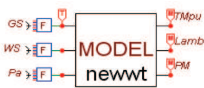
Fig. 4.34: Bloque MODEL que implementa la ecuación de la turbina eólica
