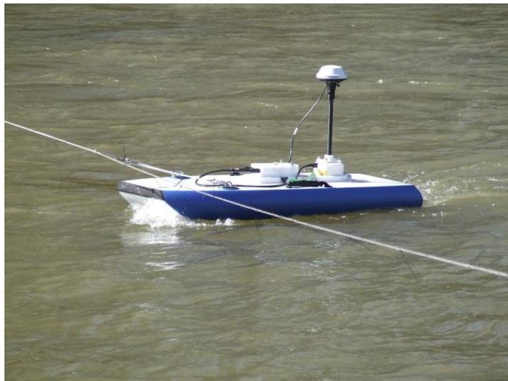
**Figura 4.** Medición de caudales con ADCP desde plataformas móviles comandadas con cables.
