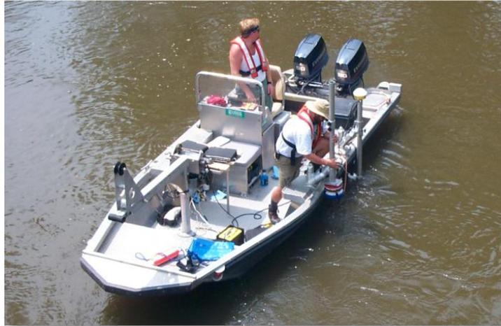
**Figura 3.** Medición de caudales con ADCP desde embarcaciones comandadas.
