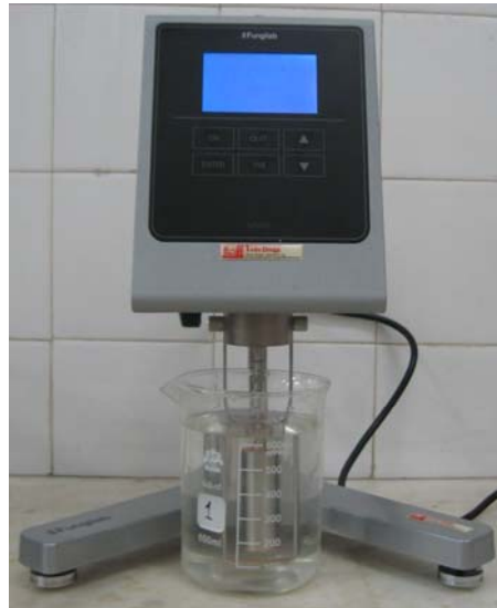
Figura 5.6: Fotografía del viscosímetro Fungilab.
