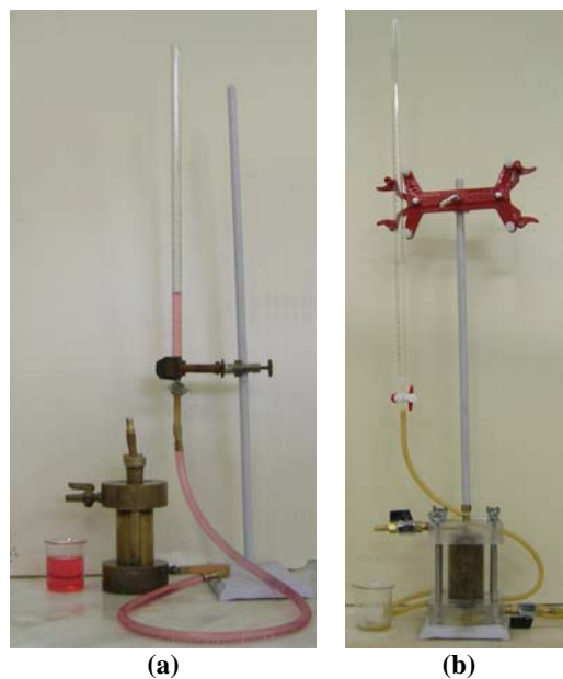
Figura 5.3: Esquema empleado para los ensayos de conductividad hidráulica. a) permeámetro de bronce, b) permeámetro de acrílico.
