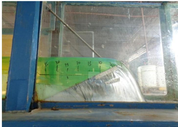
**Figura 32. Compuerta la salida canal experimental.**
