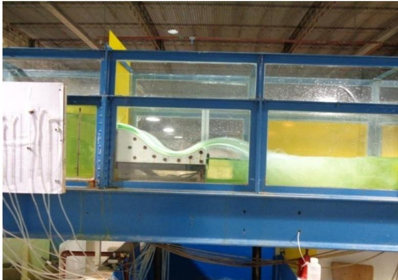
**Figura 31. Modelación física en laboratorio caso con compuerta de entrada y la salida del canal.**
