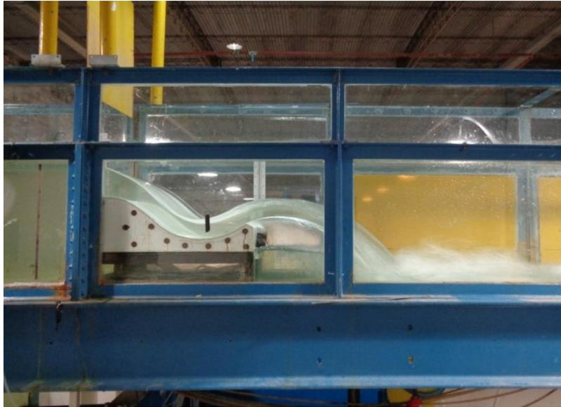
**Figura 15. Modelación física en laboratorio caso sin compuerta.**
