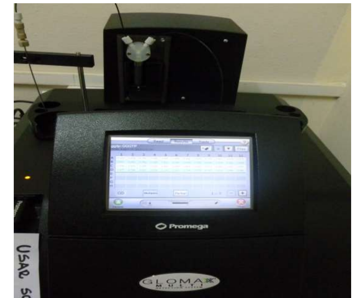
Medición en el lector de ELISA de la concentración de proteínas a 600 nm.
