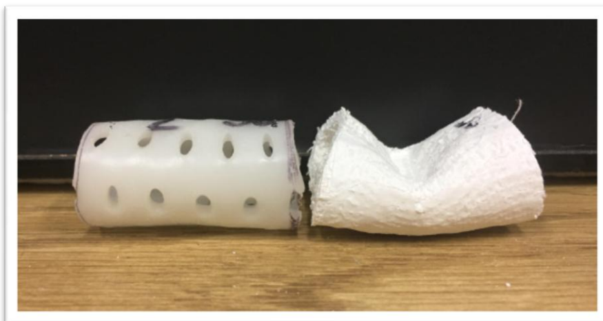
Ilustración 32: Especímenes de prueba luego del ensayo de flexión.
