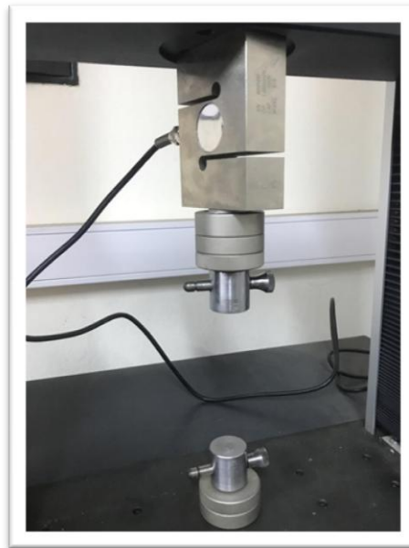
Ilustración 14: Accesorios de compresión
