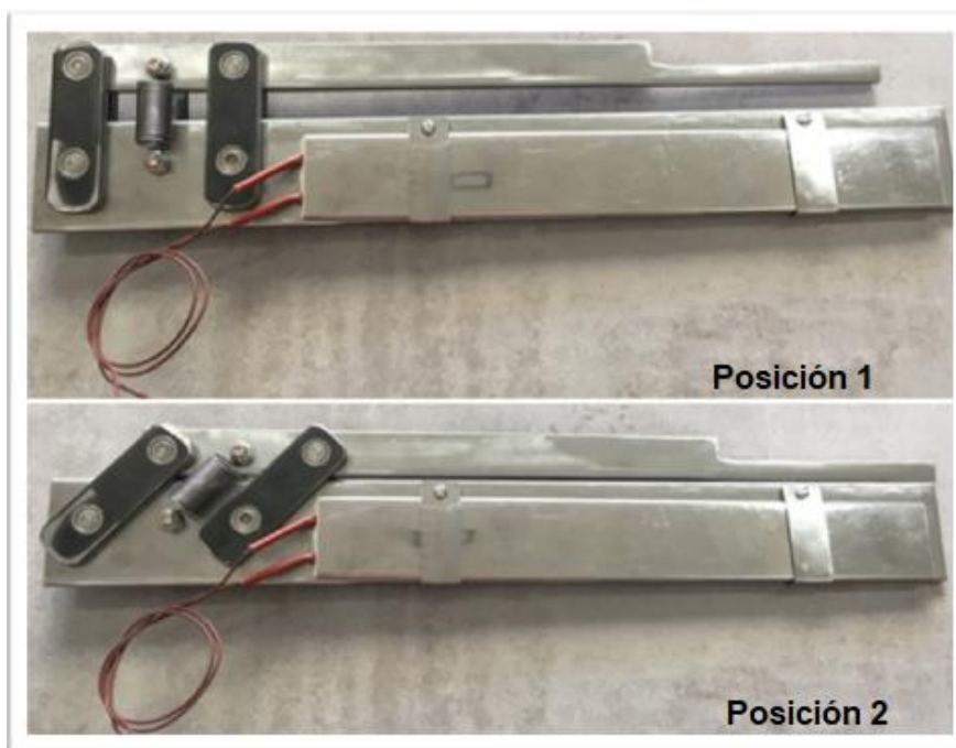
Ilustración 20: Movimiento de la Selladora.
