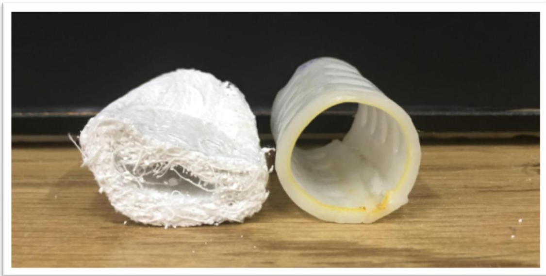
Ilustración 33: Especímenes de prueba luego del ensayo de impacto.
