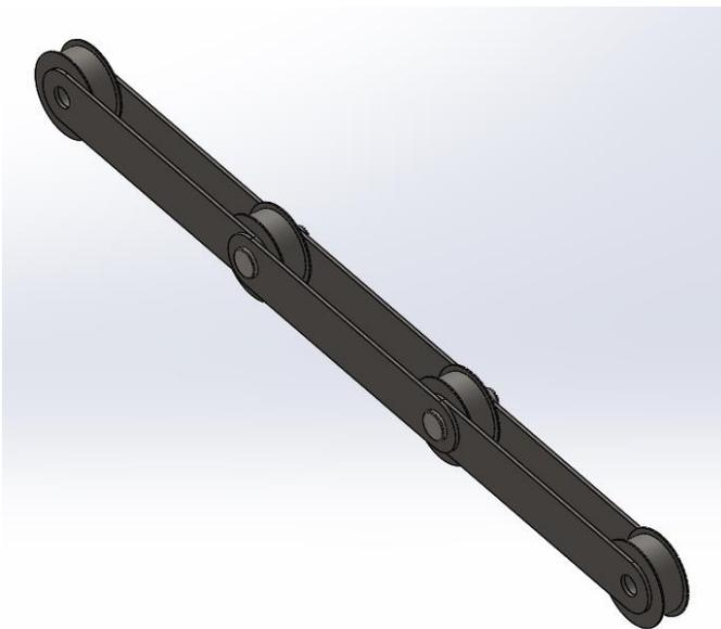
*Figura 22. Ensamble, eslabones cadena de rodillos.*
