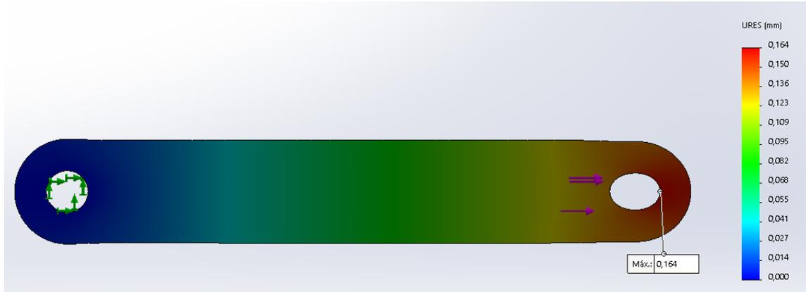
Figura 20. Malla cadena, Deformaciones. Imagen ampliada
