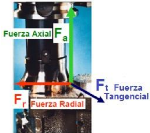
Figura 3.3 – Componentes de las fuerzas de corte
