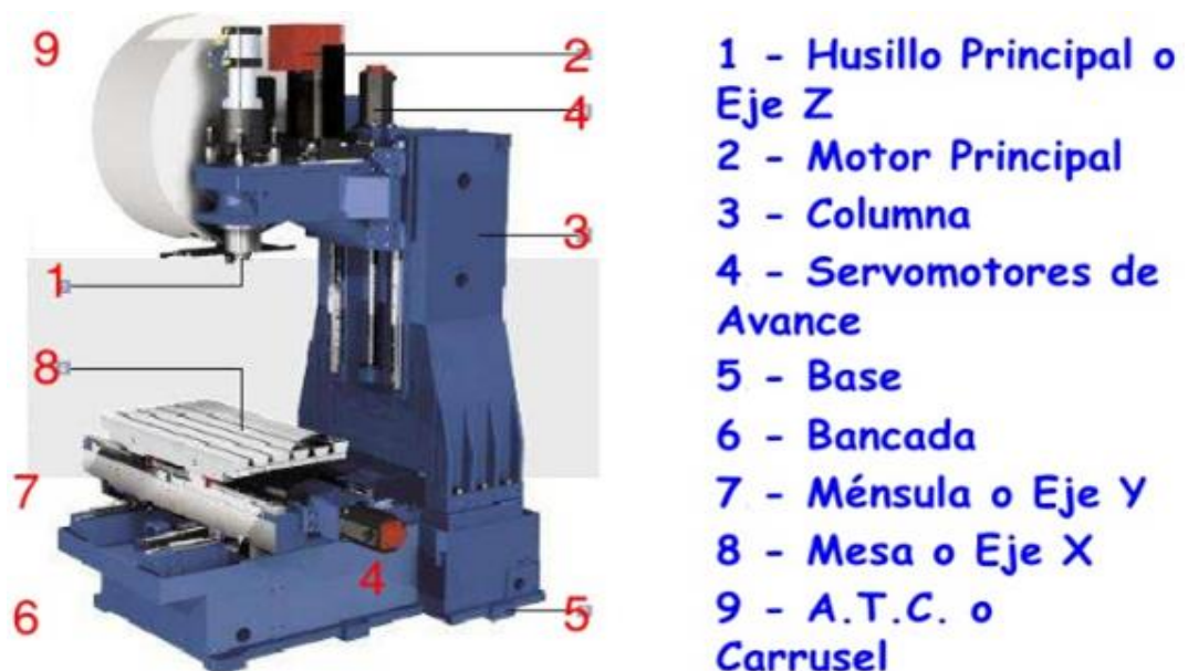
Figura 1.3 - Centro de mecanizado a husillo vertical sin el carenado exterior
