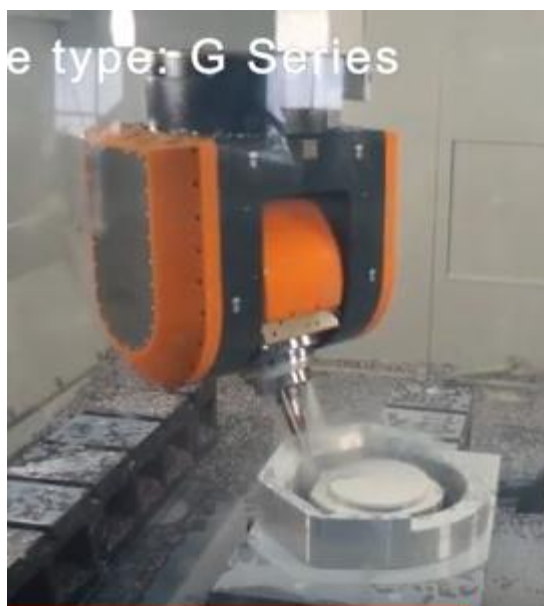
Figura 1.23 - Representación de un centro de mecanizado 5 ejes con posibilidad de movimiento en los ejes rotativos C y (A O B) según corresponda en el cabezal.
