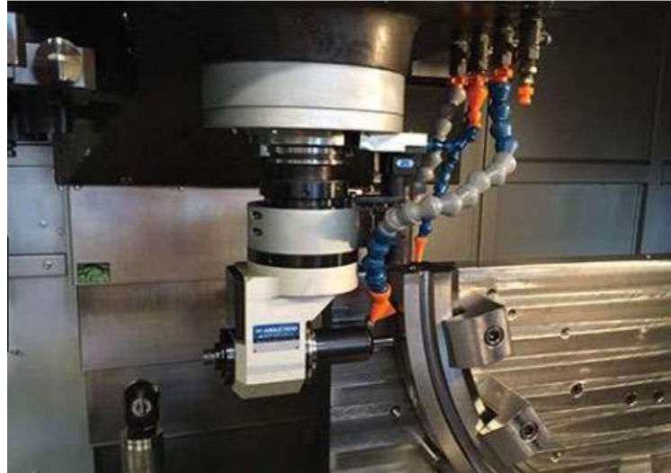
Figura 1.14 - Cabezal de ángulo recto para centro de mecanizado montado al husillo de una máquina.
