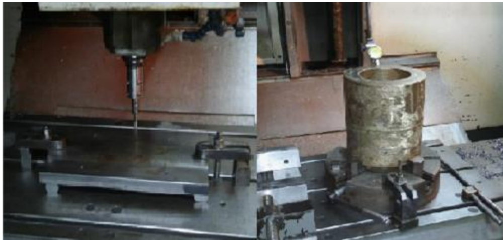
Figura 1.25 – Tomando origen primera imagen y alineando la pieza de Trabajo segunda.
