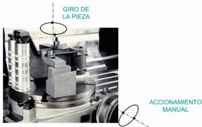
Figura 1.12 - Utillajes fresadora, Cabezal divisor y mesa giratoria ambos montados a la “mesa de trabajo” de la fresadora
