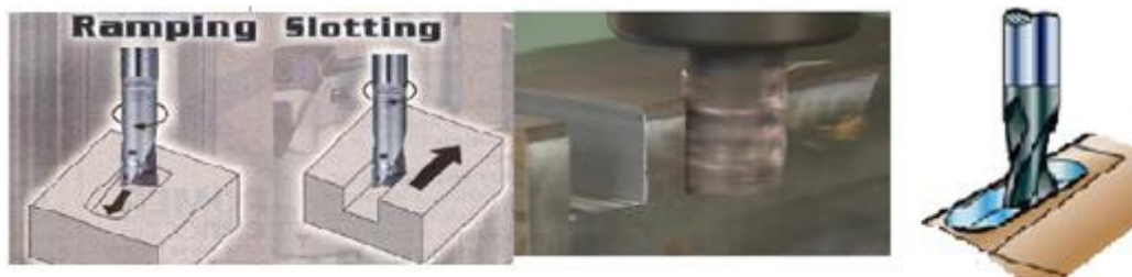
Figura 1.8 – Esquemas y centro de mecanizado mostrando distintos ranurados.
