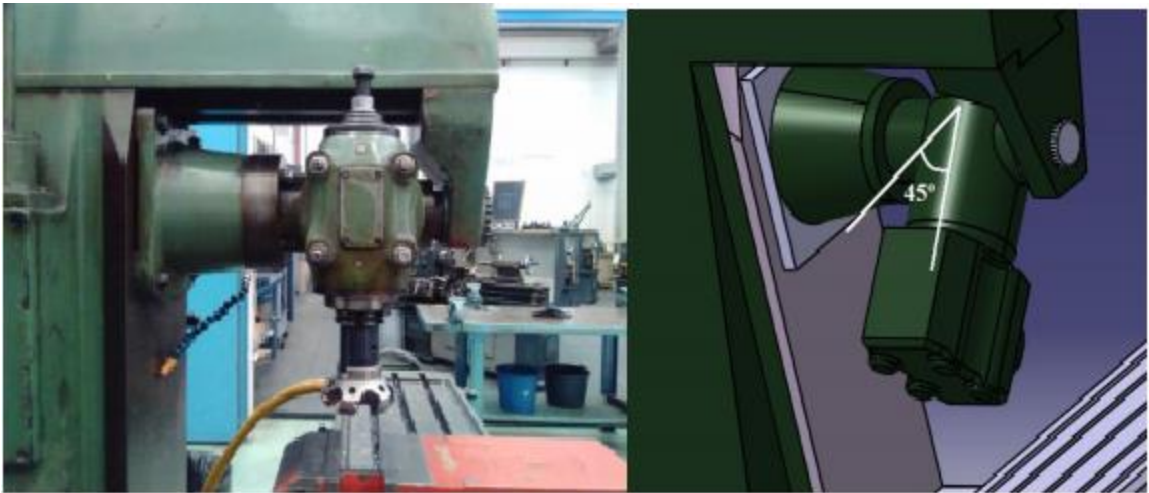
Figura 1.11 - Cabezal para fresado vertical en una fresadora horizontal montado al “husillo” de la máquina.
