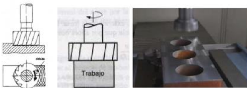
Figura 1.5 – Esquema y centro de mecanizado mostrando un planeado.
