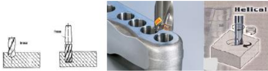
Figura 1.9 – Esquemas y centro de mecanizado mostrando un perforado con fresa y con broca.
