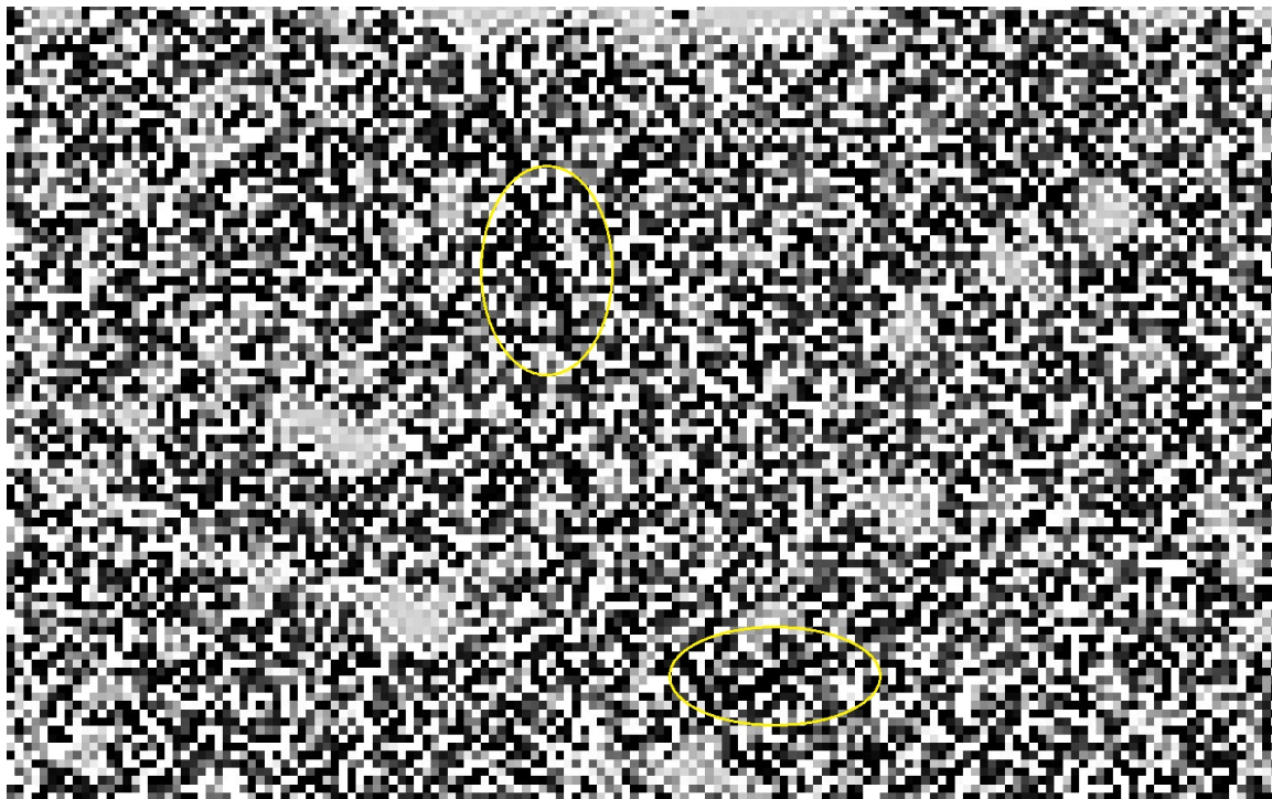
Figura 5.12: Estado del agua luego de una hora de ejecución del simulador sobre el DEM HydroSHEDS (H_sim), se observan píxeles negros como si representara una barrera para el agua.
