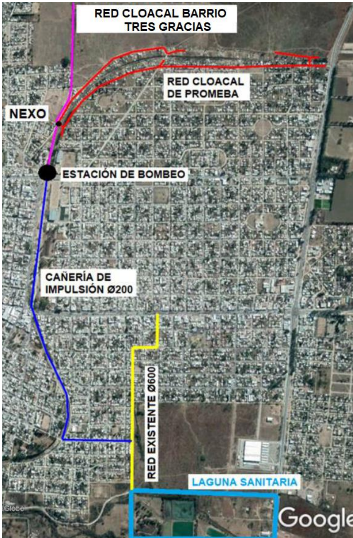
Figura 3.1: Ilustración del circuito de los líquidos residuales generados por el barrio 1º de Mayo.
