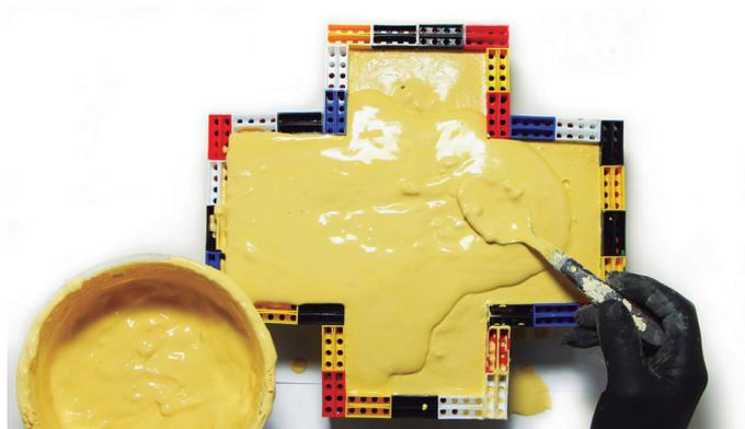
Figura 2.18 (a) Vaciado de yeso en la parte trasera del molde.
