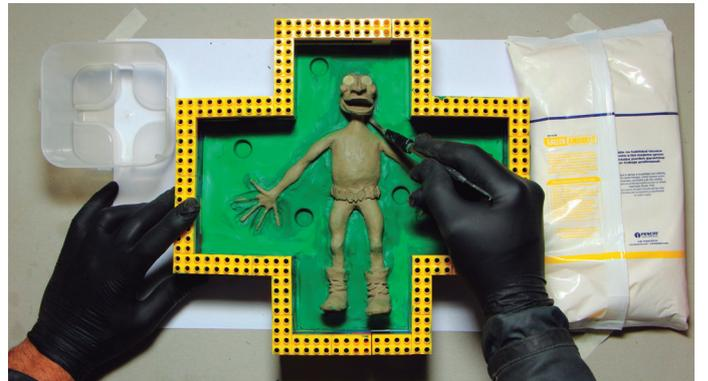
Figura 2.12(a) - (e) Secuencia de fotos del proceso de aplicación de plastilina sobre el modelo. (d) Véase el detalle de los agujeros realizados a la plastilina. A estos agujeros se los llama "llaves", ya que sirven como encaسته para ambas partes de la matriz, permitiendo que calcen a la perfección y se evite el desplazamiento.
