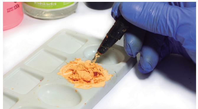
Figura 4.10 (b) Preparación de silicona con pintura acrílica.
