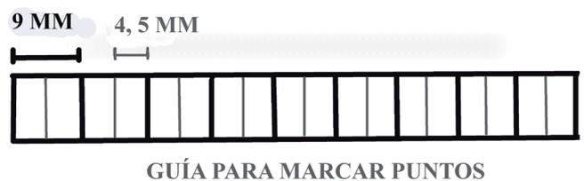
Figura 3.7 Guía para marcar los puntos de agujereado.
