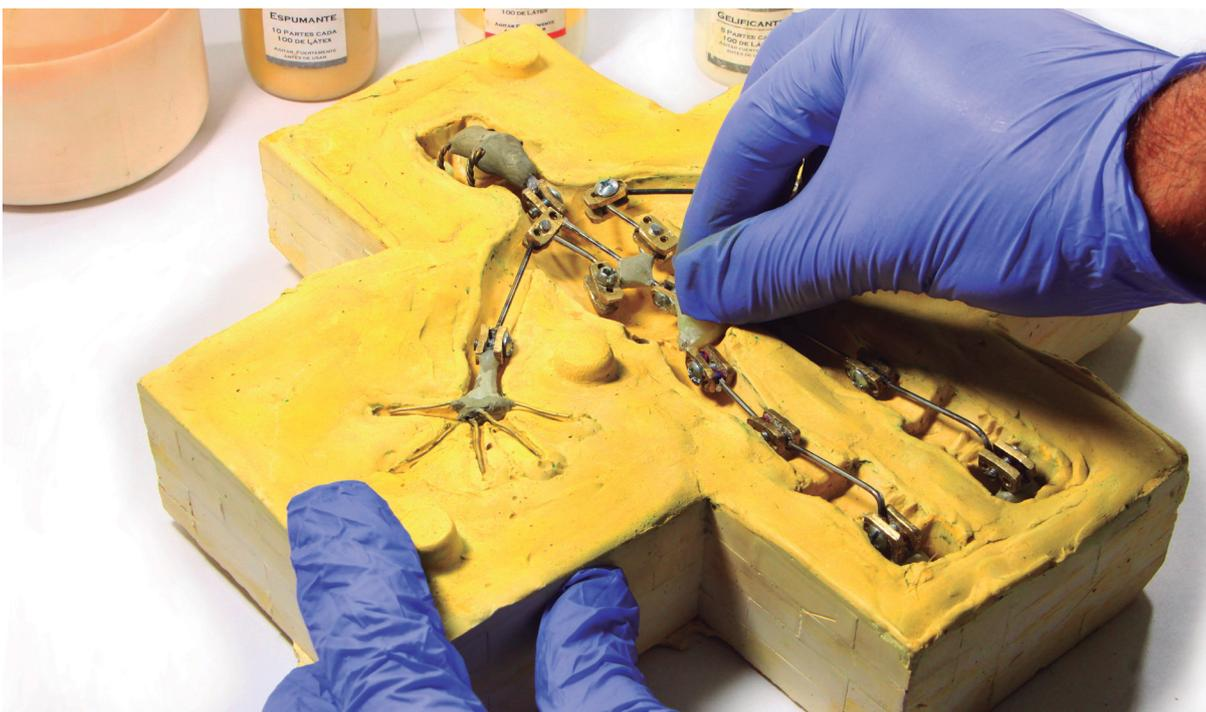
Figura 4.1(a) - (c) Posicionamiento de perla y esqueleto en molde de yeso.
