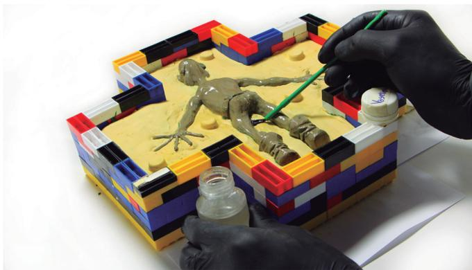
Figura 2.17 Aplicación de vaselina en la parte trasera del molde.
