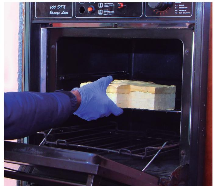
Figura 4.5 Curado de látex al horno
