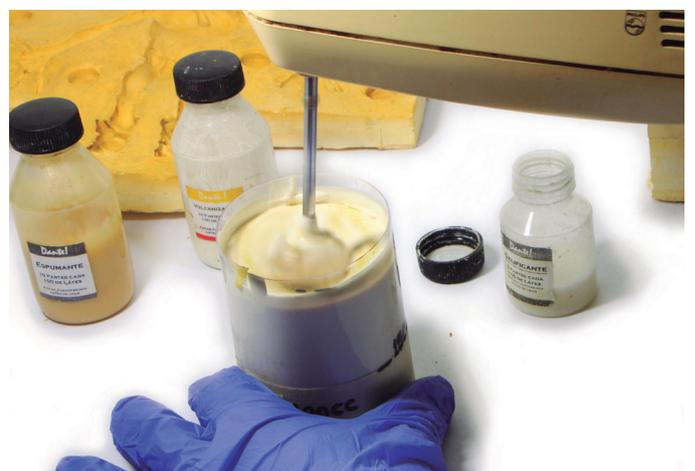
Figura 4.3 (b) Agregado de gelificante y batido
