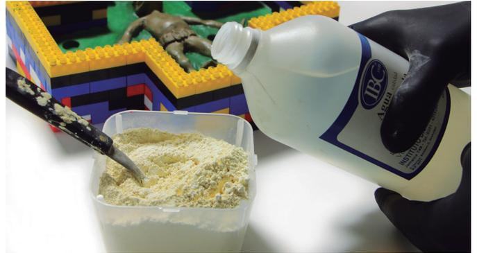
Figura 2.14 Agregado de agua al yeso.
