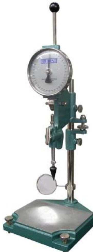
Figura 3.13: Penetrómetro de cono utilizado en la determinación de la resistencia al corte.
