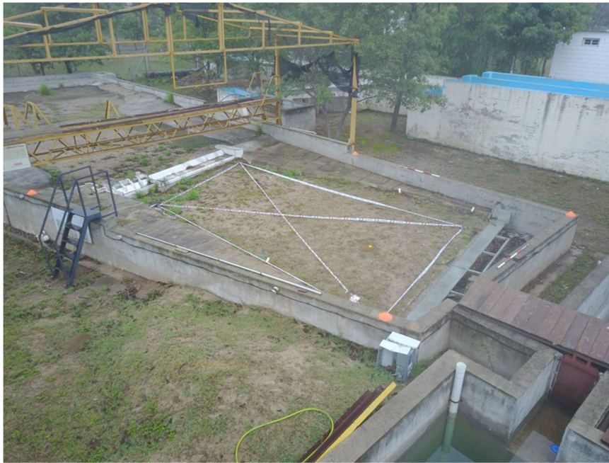
Figura 93: Modelo Físico del Dique “Los Molinos” con los elementos de fácil visibilidad
