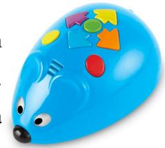
El robot replica la forma de un ratón y tiene en la superficie un conjunto de 7 teclas con las que se puede programar.
