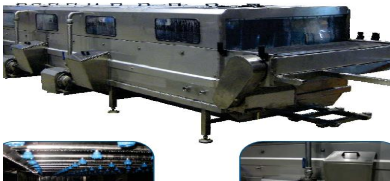
Figura A.21. Túnel de enfriado y pasteurizado.
