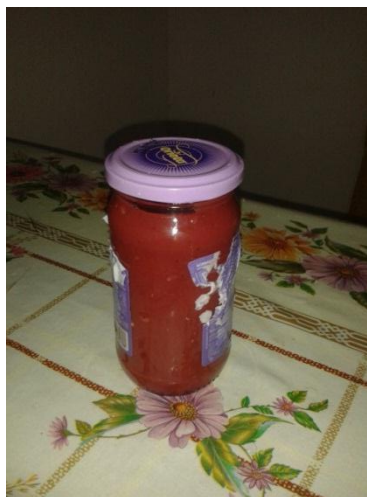
Figura A.31. Daño en etiqueta.
