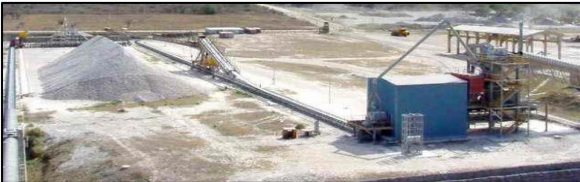
**Figura 3-4:** Parque de preparación y trituración de la materia prima
