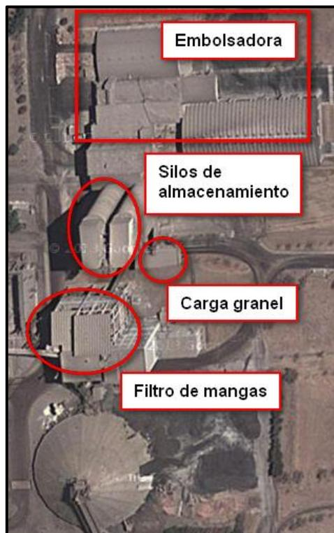
**Figura 3-17:** Vista satelital carga granel y embolsadora
