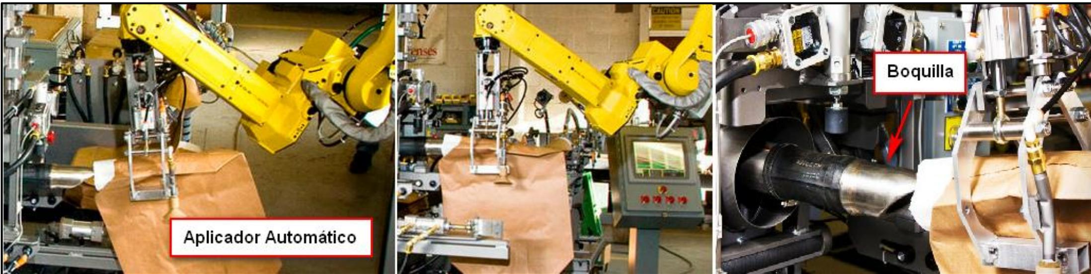
Figura 3-27: Procedimiento de aplicación de saco en boquilla
