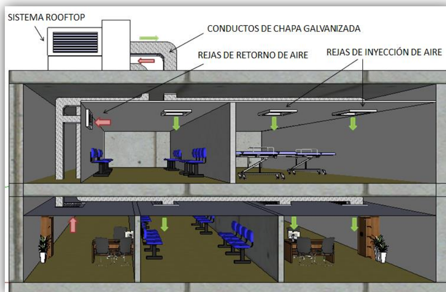
Figura 2-6. Esquema de componentes de sistema centralizado de acondicionamiento de aire
