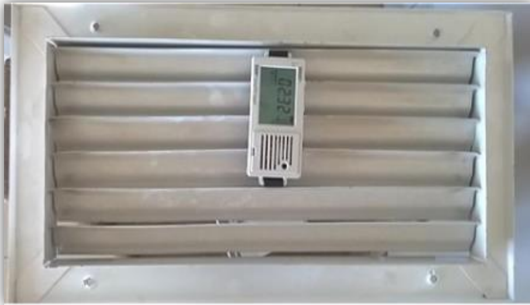
Figura 3-12. Instalación de Hobo N° 3 en el interior de la Reja de Retorno de Oficina de Administración
