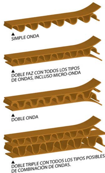
Figura 12: Clasificación de estructuras del cartón – Cartoneto
