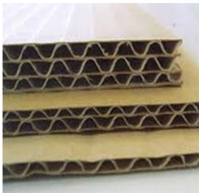
Figura 11: Estructuras del cartón
