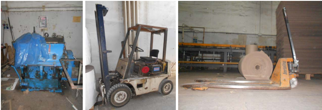
Figura 20: Traqueladora (izquierda) y medios de elevación (derecha).
