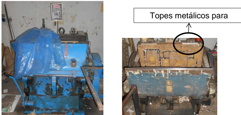
Figura 41: Troqueladora sin (izquierda) y con mejora (derecha).
