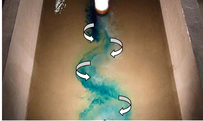
Figura 2.4: Visualización (mediante el uso de trazadores) de estructuras del tipo ET en la interfase de mezcla de la confluencia para la condición 2.1.
