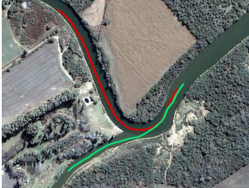
Figura 5.6: Trayectorias longitudinales en la línea central de los ríos donde se midió la elevación de la superficie libre. Verde: Río Saladillo, Rojo: Río Tercero.
