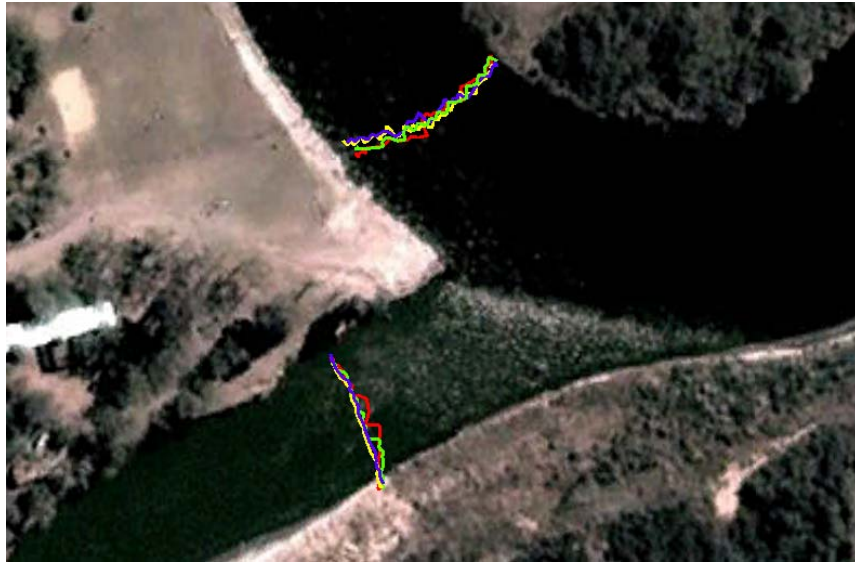
Figura 5.7: Transectas en los tributarios para determinar los parámetros hidráulicos aguas arriba.
