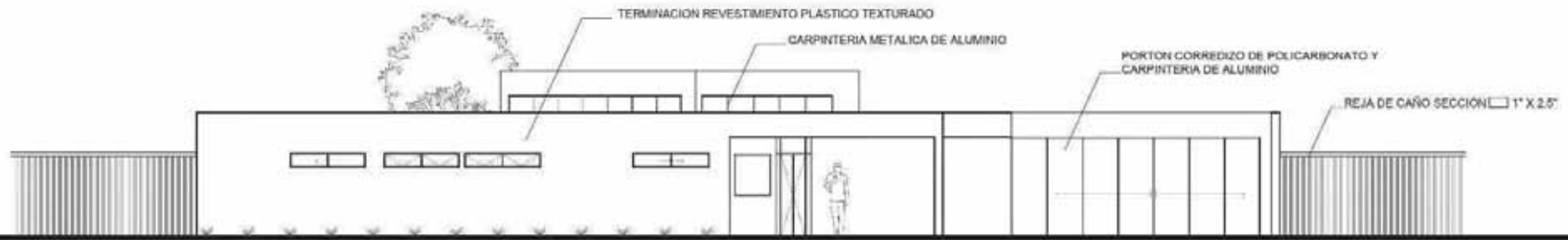
FACHADA SOBRE CALLE FADER ESC 1.100
