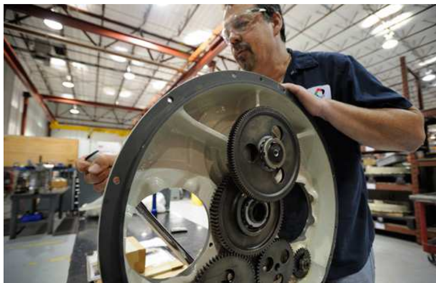
Figura 33: Armado de caja de accesorios.
