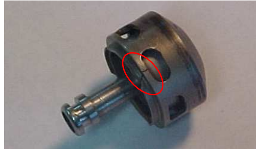
Figura 24: Grieta en inyector de combustible.
