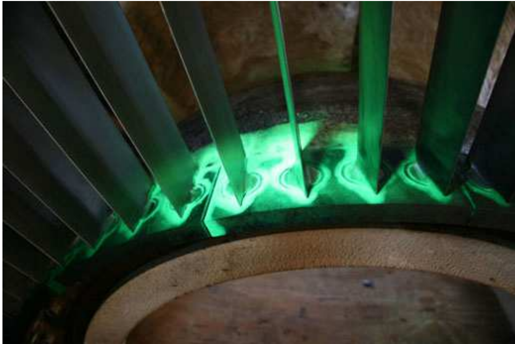
Figura 22: Pieza con aplicación de tintas penetrantes fluorescentes.
