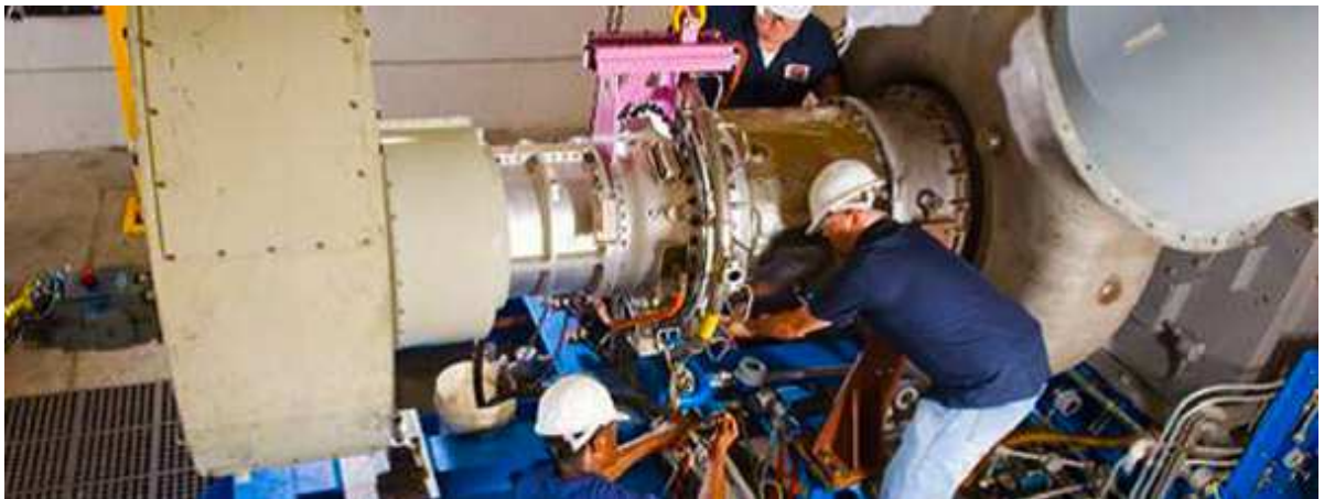
Figura 34: Armado del motor.
