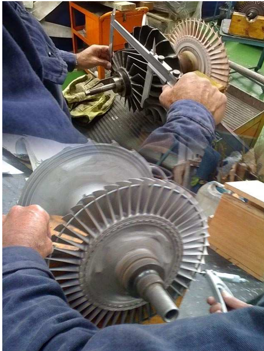
Figura 30: Inspección de rotores.
