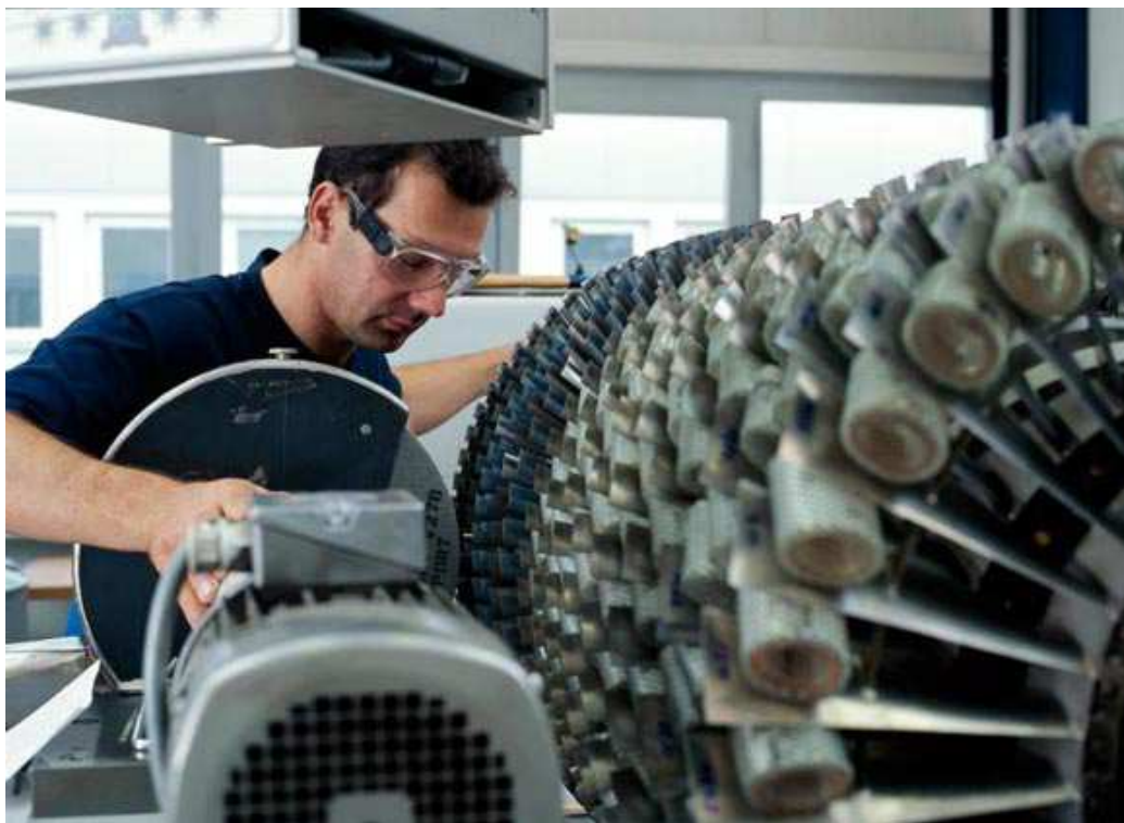
Figura 31: Rectificado de álabes de compresor.
