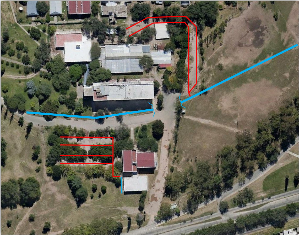
Fig. 3.10 Sistema de cunetas de desagüe
