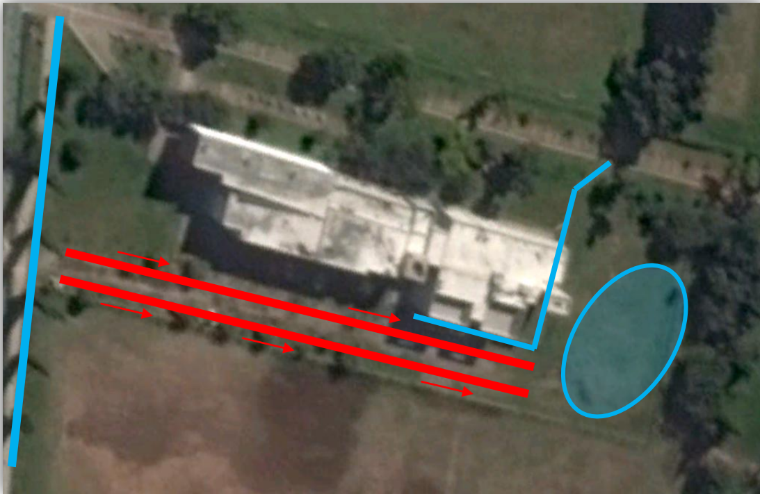
Fig. 5.12 Solución de desagüe
