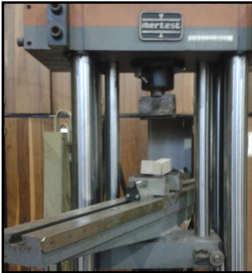
Imagen 4.7. Probetas prismáticas, ensayo de flexión.
