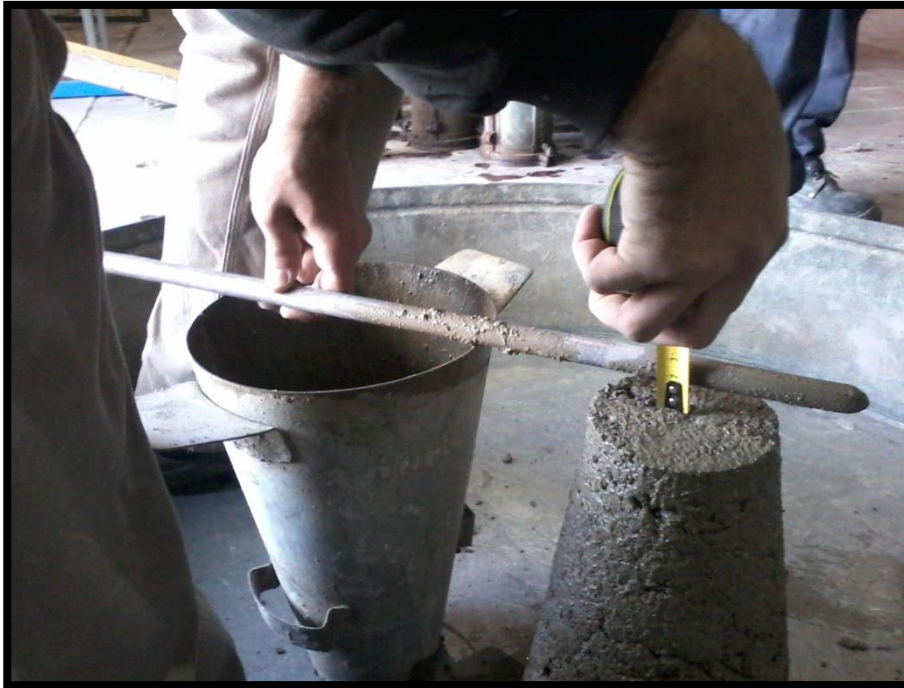
Imagen 5.7. Preparación de probetas. Pastón con 50% de reemplazo.
