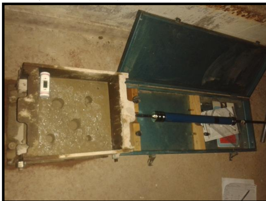
Imagen 5.12. Probeta para ensayo de penetración, penetrómetro y termómetro.
