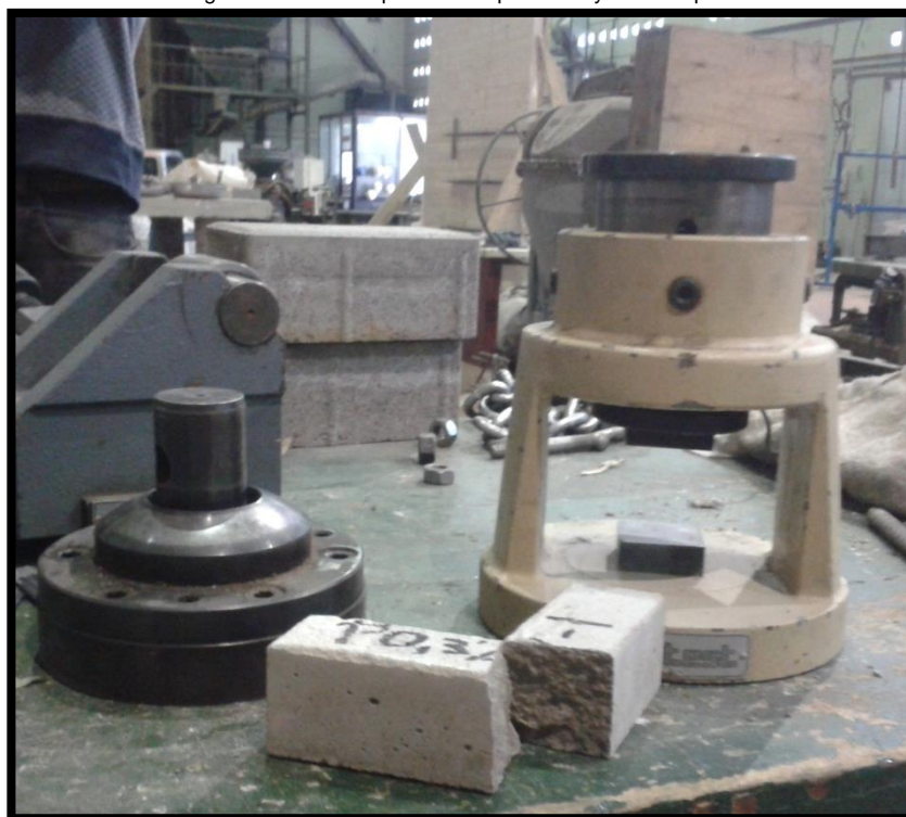
Imagen 4.8. Probetas prismáticas para ensayo de compresión.
