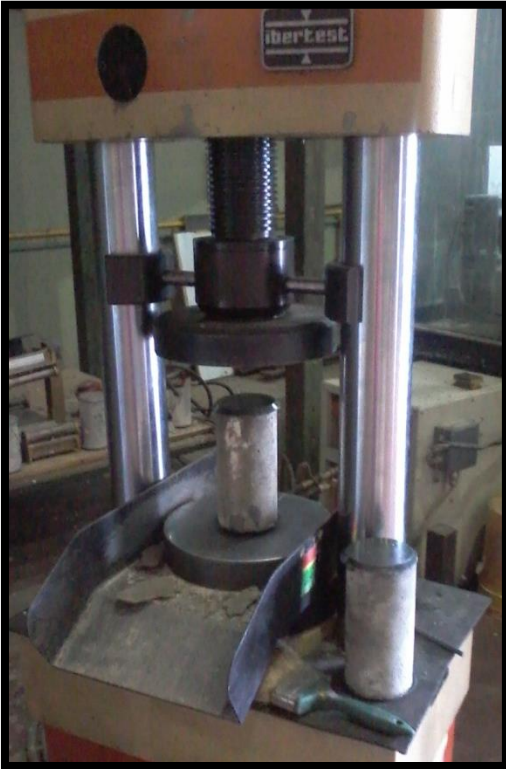
Imagen 5.10. Control de prensa para realizar ensayo de compresión.
