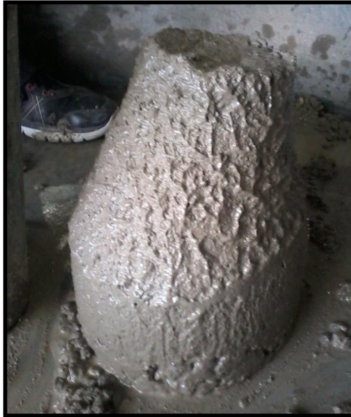
Imagen 5.4. Cono de hormigón, medición de asentamiento. Pastón patrón.
