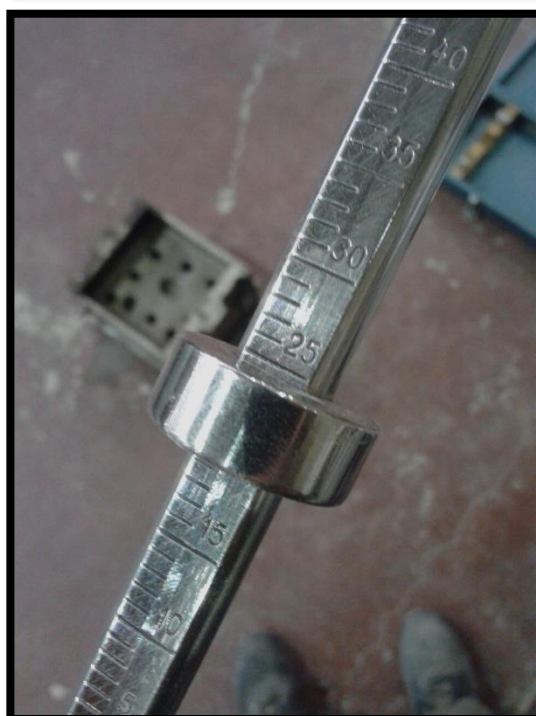
Imagen 5.13. Regla graduada para medición de fuerza de penetración.
