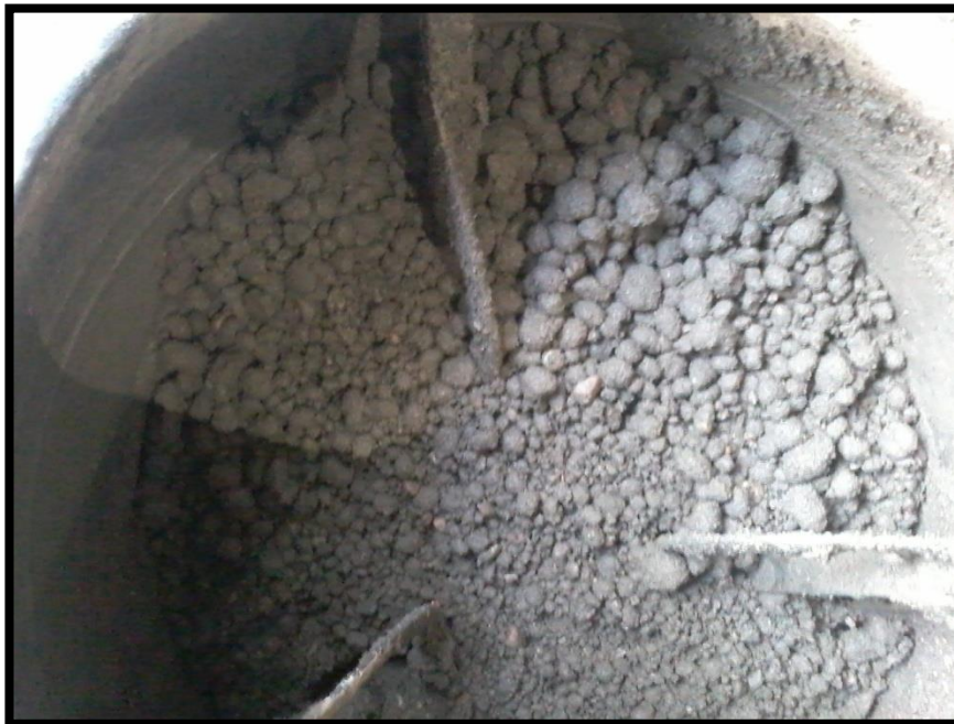
Imagen 5.5. Mezcla pastón 50% de reemplazo.
