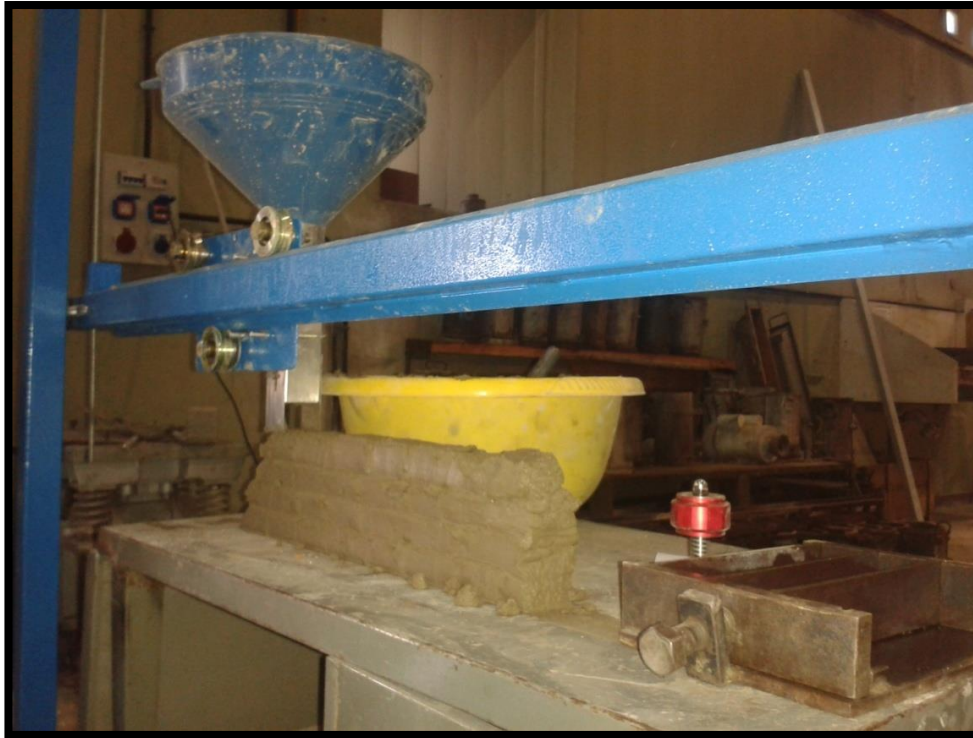
Imagen 9.1. Prueba de colado de mortero para impresión 3D.
