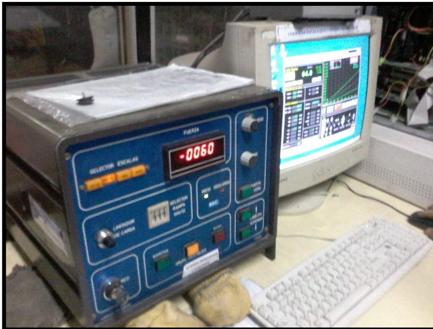
Imagen 5.10. Control de prensa para realizar ensayo de compresión.
