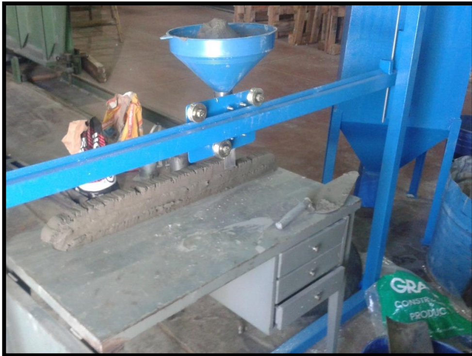
Imagen 9.2. Prueba de colado de mortero para impresión 3D.
