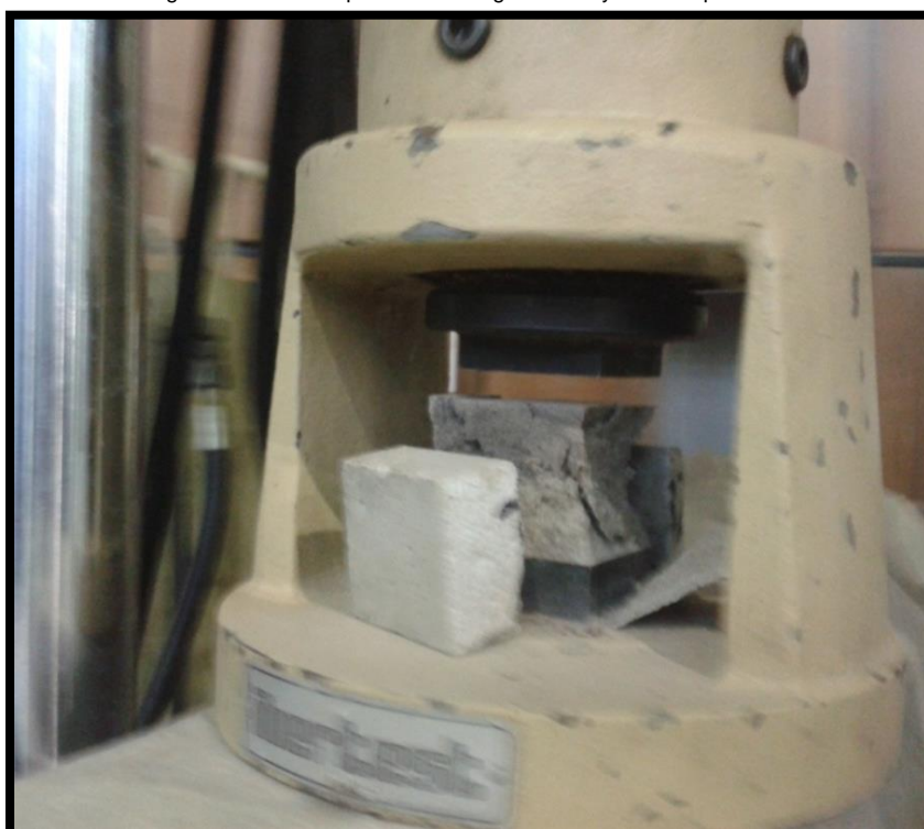
Imagen 4.9. Probetas prismáticas luego de ensayo de compresión.
