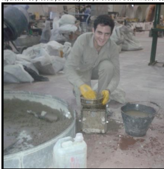
Imagen 5.11. Preparación de probeta para ensayo de penetración. Determinación de tiempo de fragüe.
