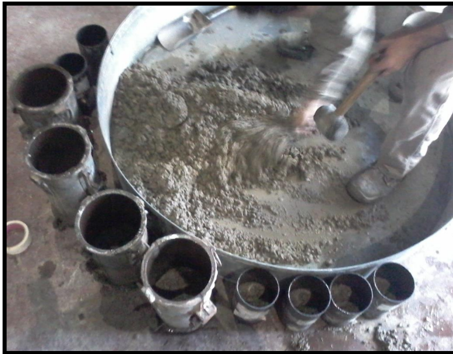
Imagen 5.7. Preparación de probetas. Pastón con 50% de reemplazo.
