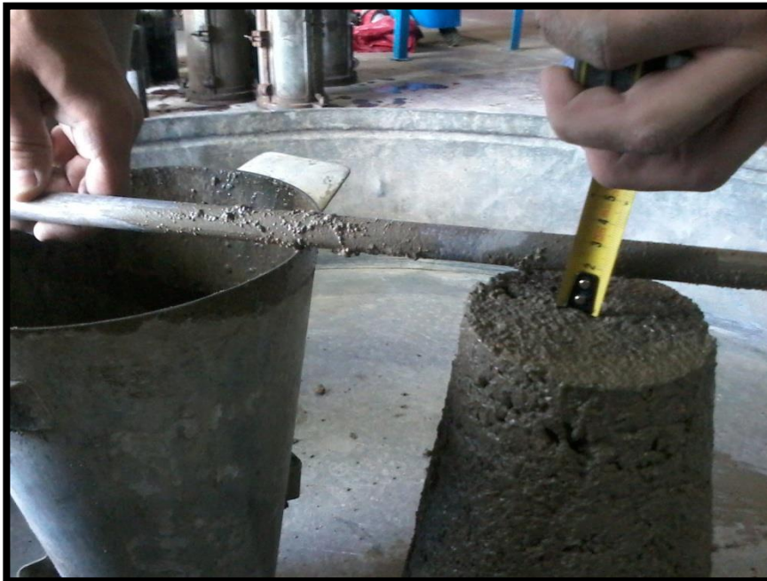
Imagen 5.3. Medición de asentamiento, cono de Abrams. Pastón 50% de reemplazo.
