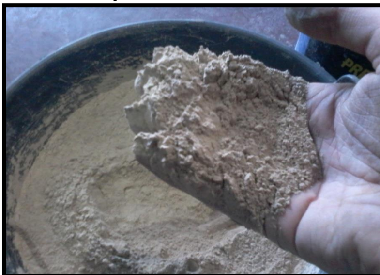
Imagen4.1. Toba zeolítica, muestra laboratorio.
