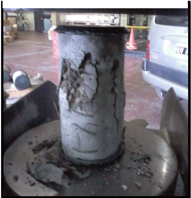
Imagen 5.10. Control de prensa para realizar ensayo de compresión.
