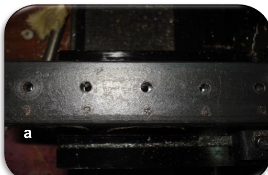
Fig. 38 a) y b). Escalón tope fresado para cada implante.
