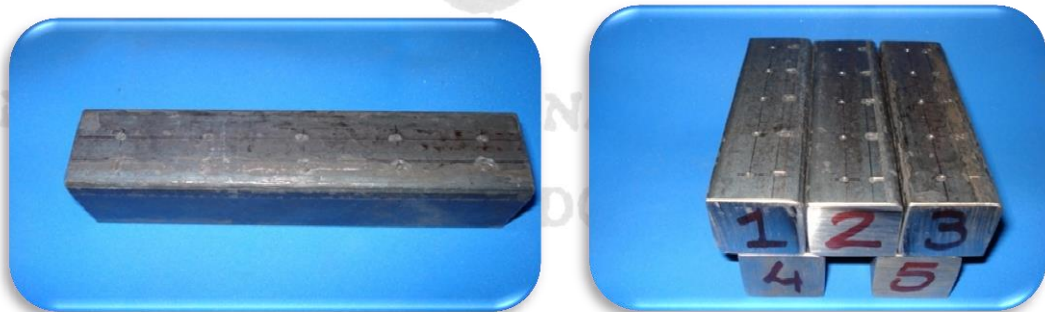
Fig. 33 y Fig. 34. Bases para fijación en el ensayo mecánico.
