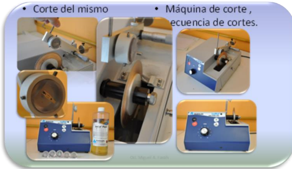
Fig. 89 Microcortadora Isomet Bueler, cortando el bloque de resina con inclusión.
