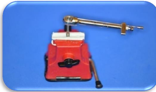
Fig. 64. Morsa plástica sosteniendo sistema de implante para ser torquizado a 35N/cm.
