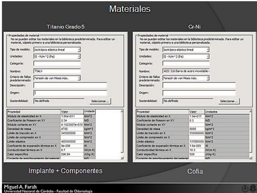
Fig. 107 Introducción de variables y condiciones para el ensayo con MEF
