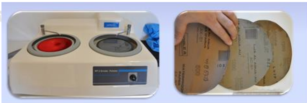
Fig. 90 Pulidora Circular Glinder Polisher M-P-2 con los discos de lija de diferente granulometría.
