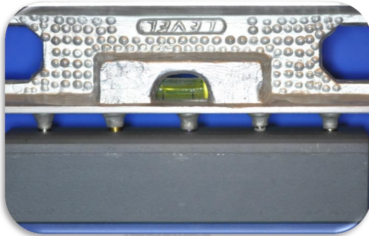
Fig. 67. Control de horizontalidad de los sistemas respecto a la base.
