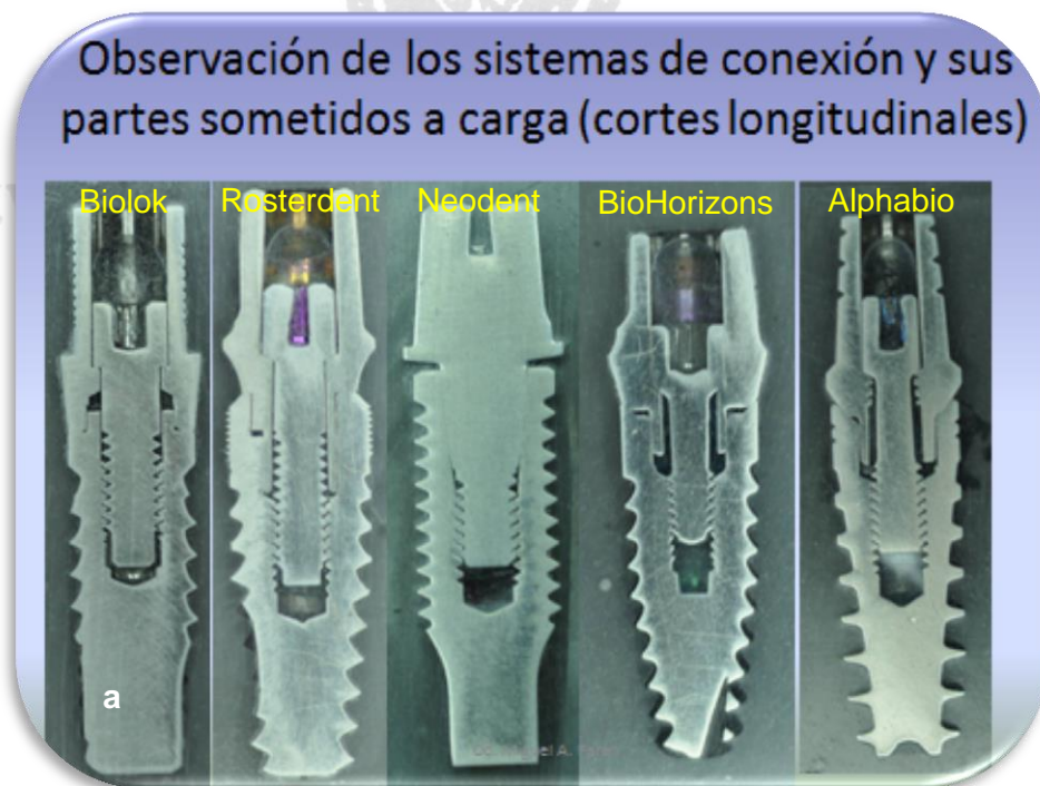
Fig. 92 a. Fotos Macro de los cortes longitudinales realizados en las muestras luego de ser sometidos a cargas.
