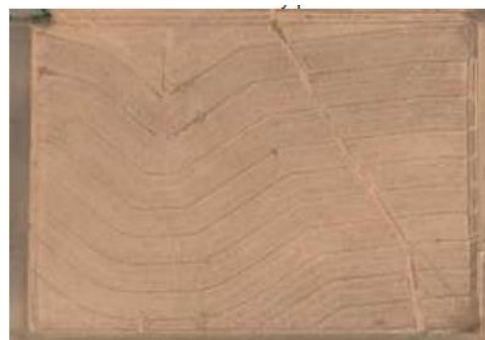
Figura N°27: Terrazas curvas paralelizadas.
