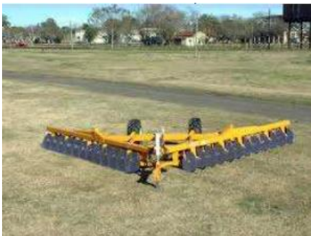
Figura N° 32: Terracedor de arrastre.
