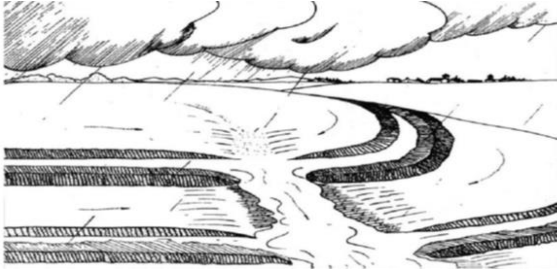
Figura N° 28: terrazas paralelas de desagüe y canal de desagüe.
