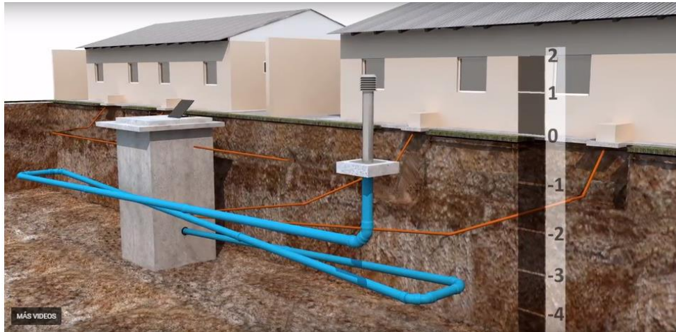
Figura 19. Esquema de instalación de geotermia en el barrio El Alto de Bariloche.
