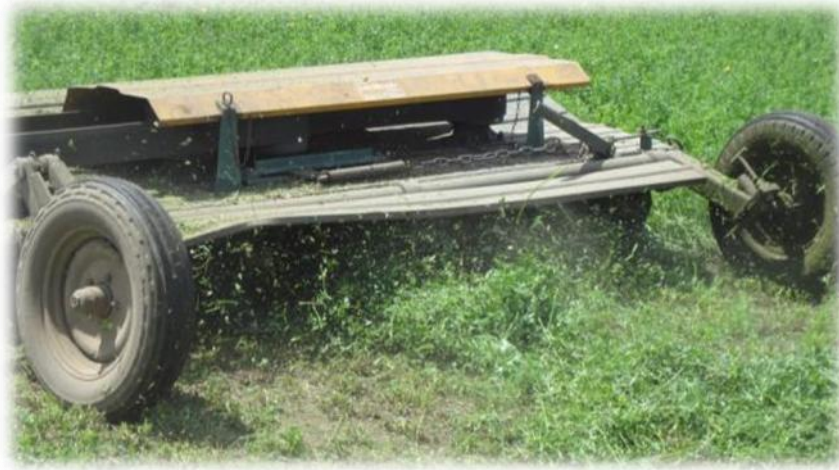
Figura 10: Cortadora tipo hélice. Efecto de repicado y voladura de hojas (Fuente: INTA Manfredi).
