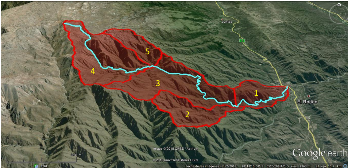
Figura 44. Cuenca con las respectivas sub-cuencas y cauce principal de río Los Nogales
