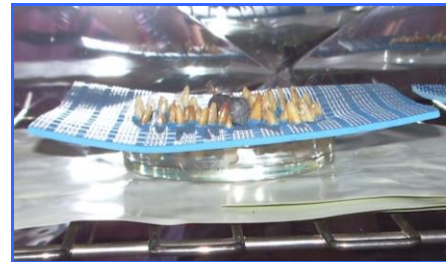
Muestras en estufa a 37C° sumergidas en saliva artificial
