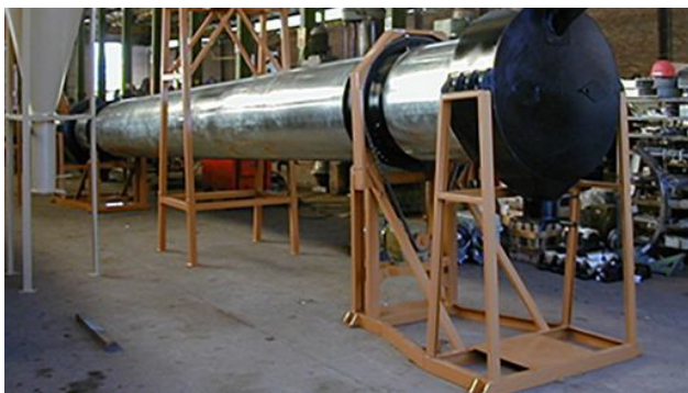
Figura 16: Máquina desactivadora de soja.
