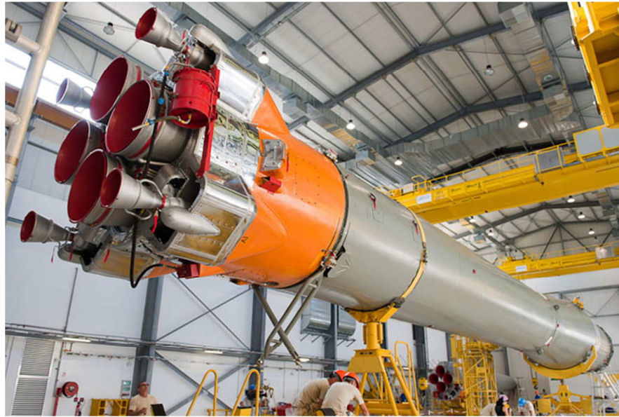
Figura 6. Motores de SCR sobre la Etapa Central de un Cohete Soyuz.
