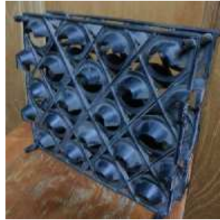
Fig.3.5 – Relleno salpicado, posición (n)
