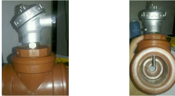
Fig.2.8 – Sensor RTD, vista lateral (izquierda), y vista frontal (derecha)
