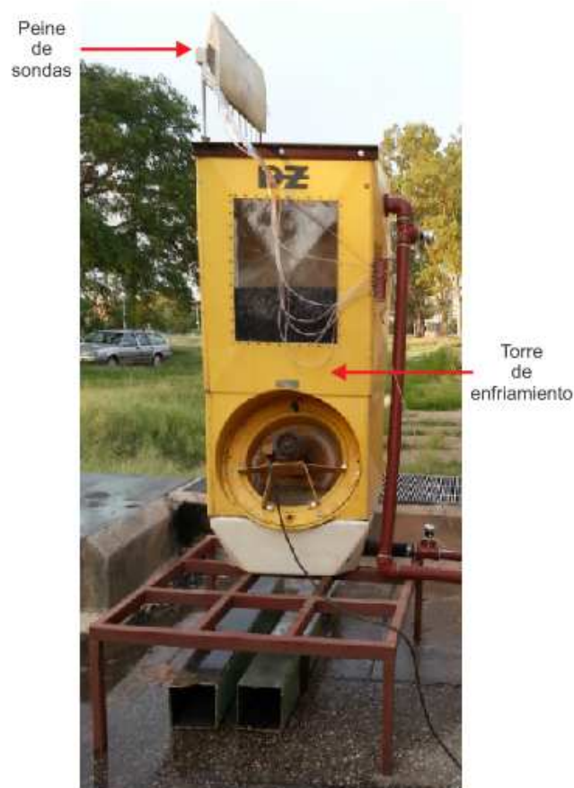
Fig.3.3 – Torre de enfriamiento y peine de sondas instalados para determinar el caudal de aire
