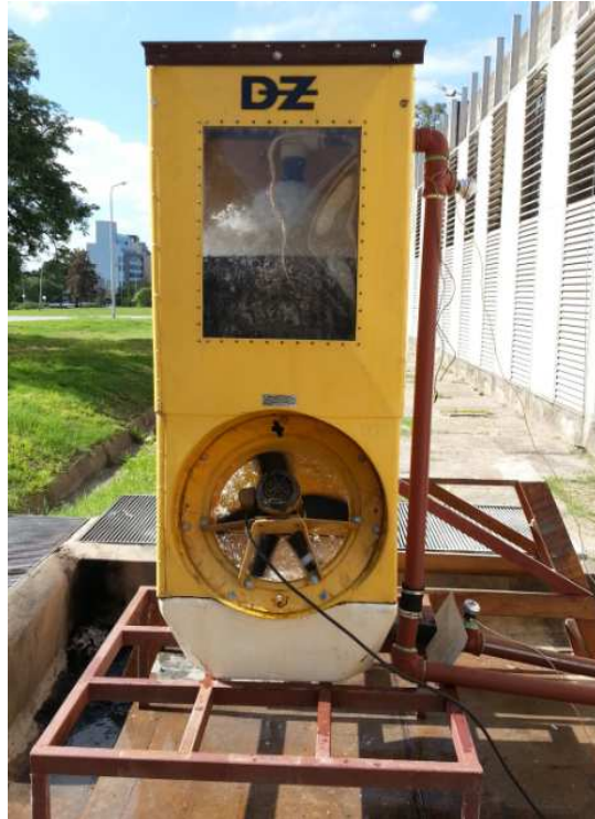
Fig.5.1 – Torre de enfriamiento y su instalación para ensayos con agua caliente
