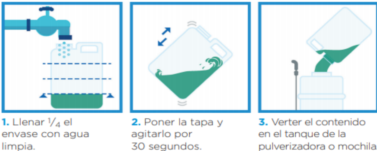
Figura 10: Técnica de Triple Lavado para envases tipo “A”.
