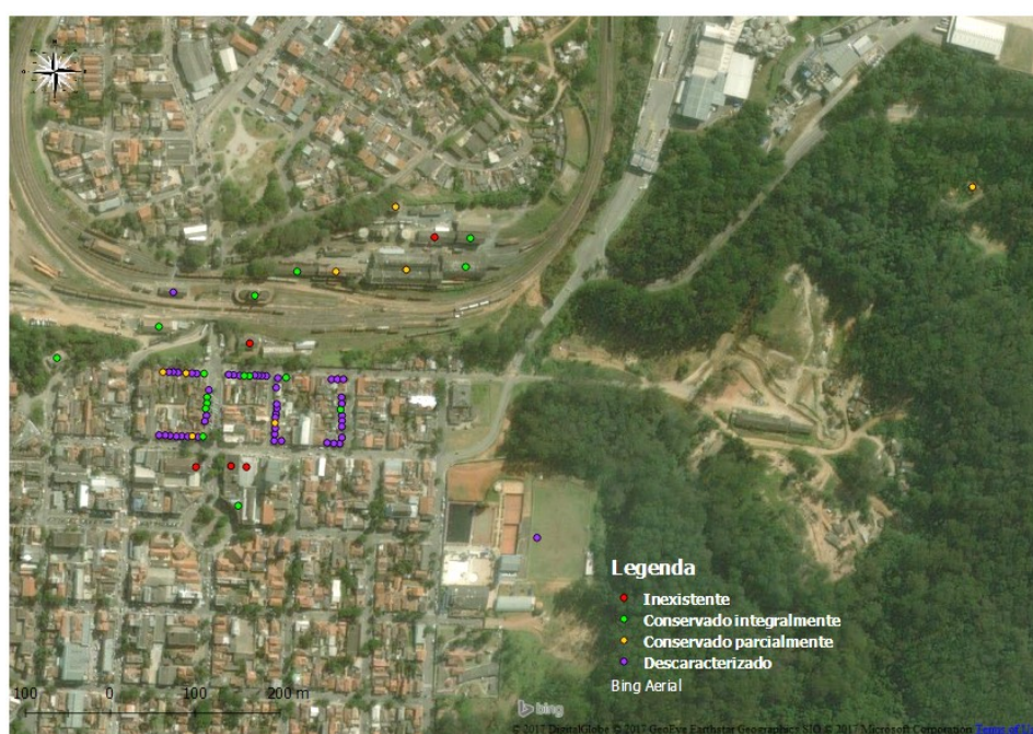
Figura 06: estado de conservação dos bens imóveis ferroviários vinculados à EFS localizados na área urbana central de Mairinque. Fonte: elaborado pela autora
