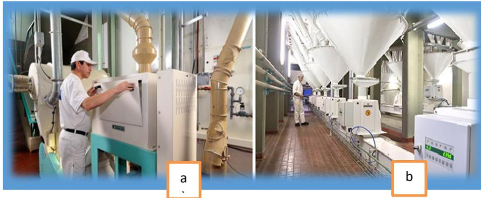
**Figura 11.a) proceso de limpieza. b) Acondicionado del trigo.**
